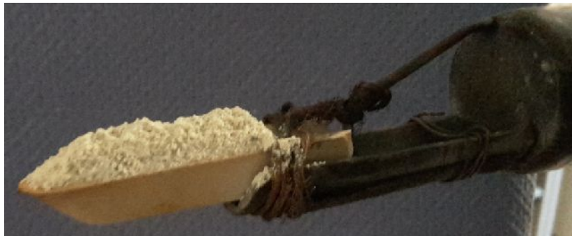
Abbildung 35: Probe am Schiffchen bereit zur Aufgabe
