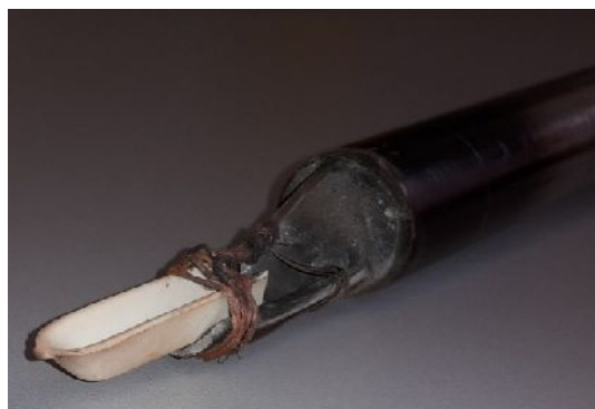
Abbildung 34: Keramikschißchen für die Probenaufnahme
