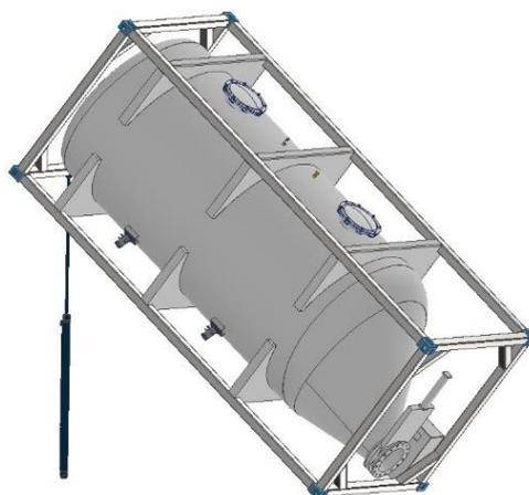
Abbildung 31: Bildliche Darstellung des diskontinuierlichen Entladevorgang von Variante 4
