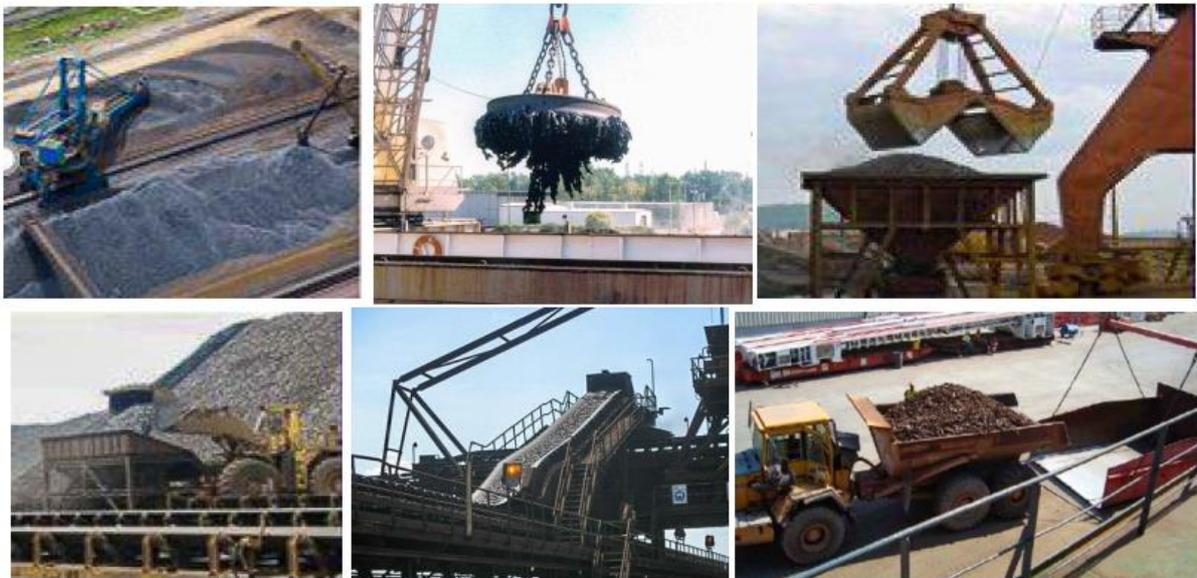
Abbildung 16: Fotocollage verschiedener Fördersystem für den Transport und Umschlag von DRI [5]
