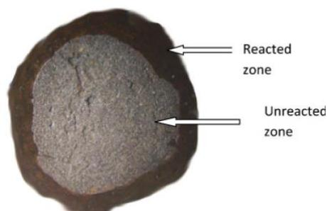
Abbildung 5: Mikrofotographie der topochemischen Struktur eines teilweise reoxidierten DRI-Pellets [7]
