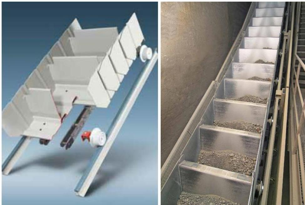
Abbildung 12: Stahlplattenband mit Stegblechen (links), Transport von Zementklinker (rechts) [14]
