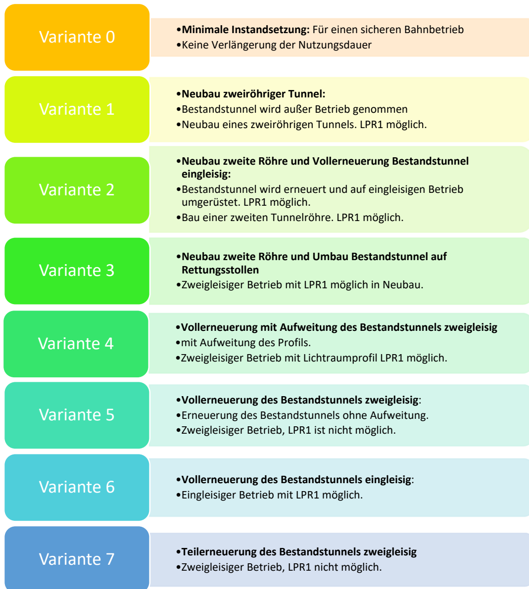
Abbildung 38: Variantenaufstellung für den Modelltunnel und vergleichbare Bauwerke.
