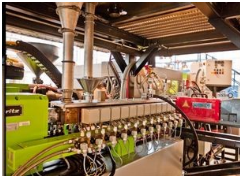
Figure 8.7: Leistritz ZSE 27 MAXX Compounder (Kunststofftechnik, 2014)
