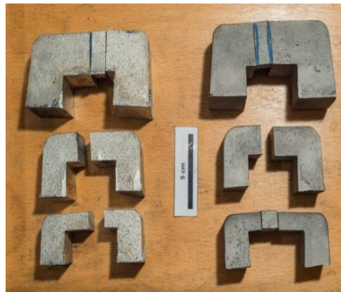
Abbildung 3-14: Geschnittene Gussteile, links- Aluminium; rechts – Gusseisen.
