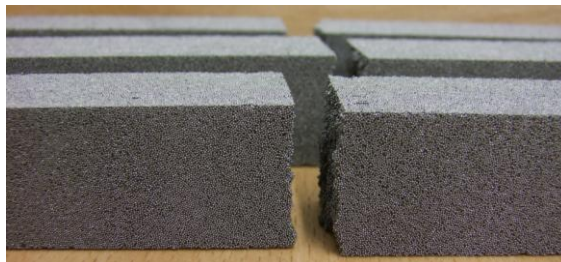
Abbildung 3-8: Gebrochene Biegeproben aus Metallgranulat.
