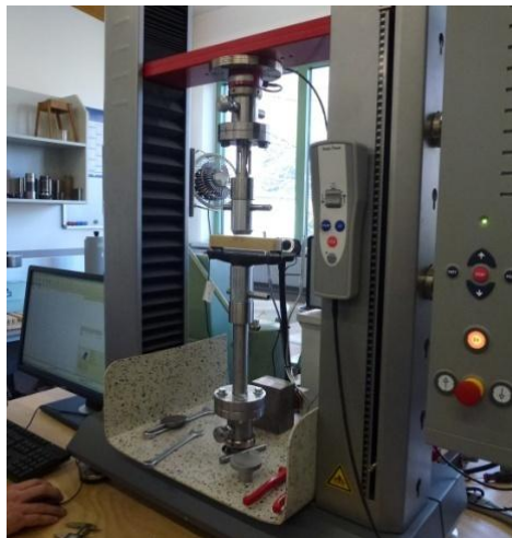
Abbildung 3-4: Elektrisch gesteuerte Prüfmaschine mit Biegeprüfvorrichtung.
