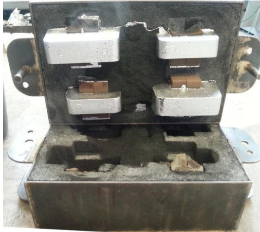
Abbildung 3-11: geöffnete Form nach dem Gießversuch.
