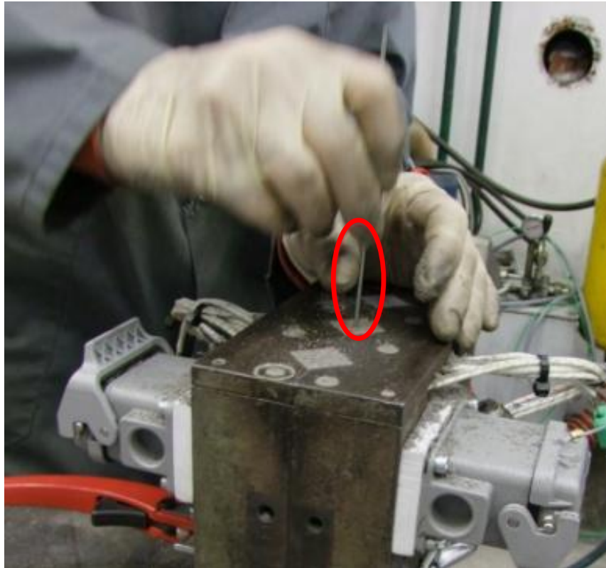
Abbildung 3-7: Kernform mit Heizelement. Biegeproben aus Metallgranulat mit Kerneisen (Draht).
