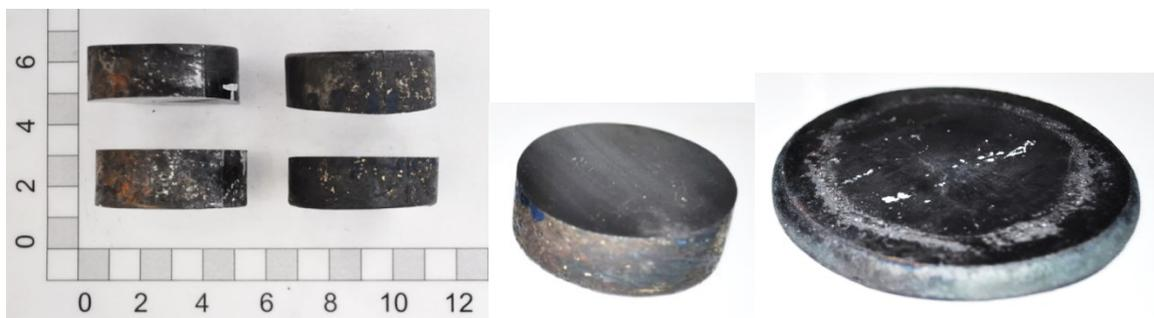
**Abbildung 3-2:** Geteiltes Probenmaterial, Probenhälfte im Gusszustand, Probenhälfte nach Umformvorgang.
