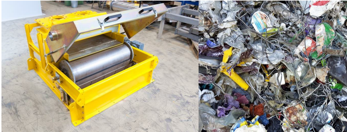
Abbildung 7: Trommelmagnetscheider und ausgeschleuste Fraktion [11]
