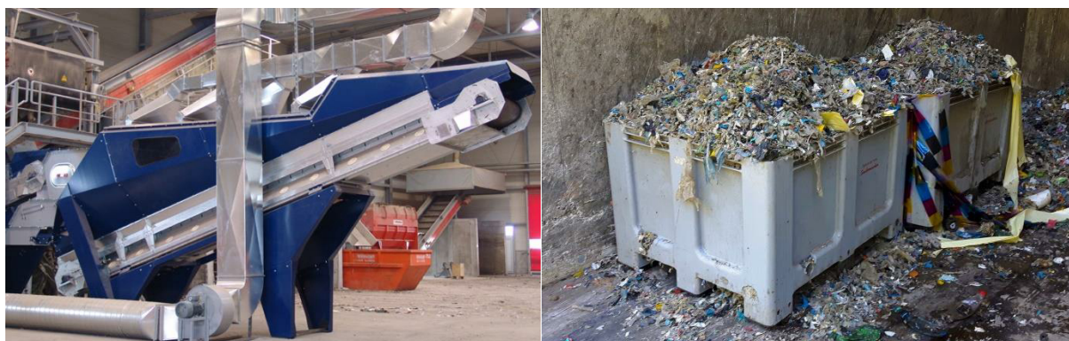
Abbildung 10: Inertstoffabscheider und abgeschiedene Fraktion [12]
