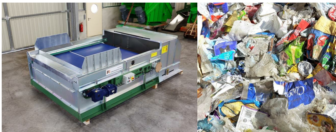
Abbildung 9: Wirbelstromscheider und ausgeschiedene Fraktion [11]
