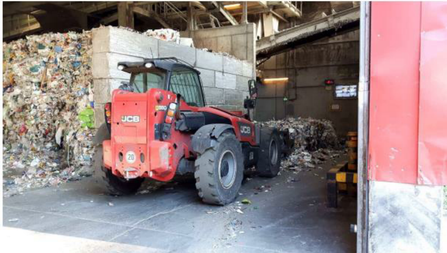
Abbildung 1: Aufgabe durch Radlader
