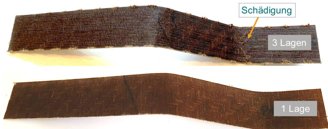
Abbildung 18: Umgeformte Proben
