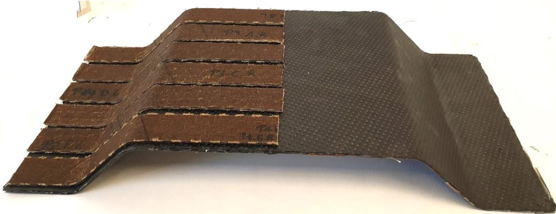
Abbildung 13: Proben auf der Unterlage in Form der Werkzeuggeometrie
