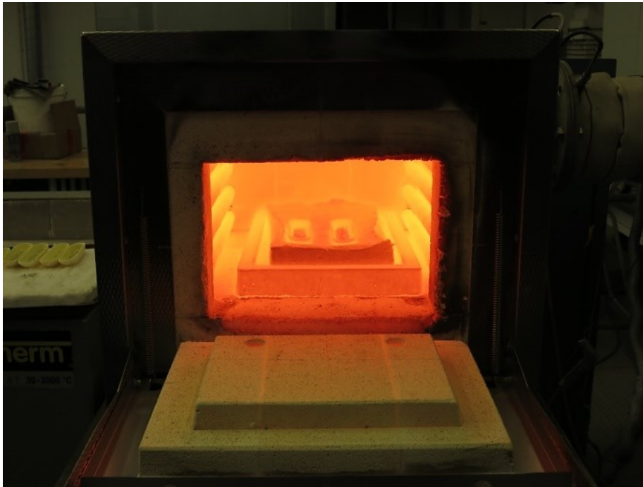
Abbildung 17: Ofeninnenraum vor der Entfernung der Proben
