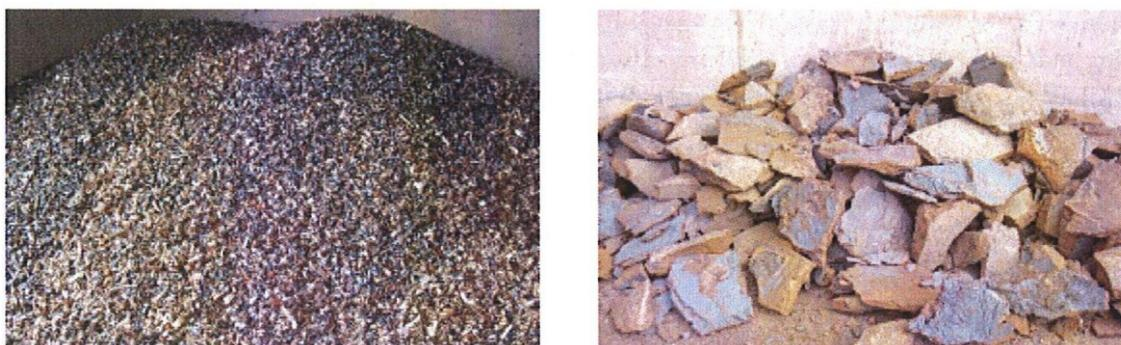
**Abbildung 3-43:** Chargierte Materialien: verwendeter Kühlschrott für den Konverter (links) und chargiertes Roheisen (fest) für EAF (rechts) <sup>[197]</sup>
