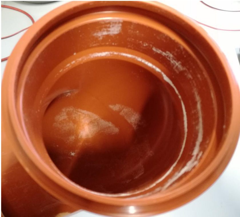
Abbildung 44: Knicke mit abgesetzten Staub
