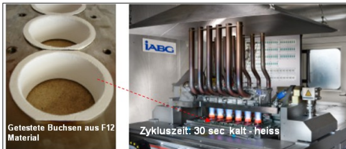
Abb. 68: Typischer Spannungs- Einsatz von Buchsen im Zylinderkopf-Prüfstand der IABG mbH bei extremen Thermoschocks [59].
