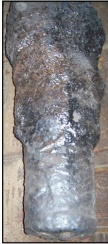
Abb. 29: Verbärung der Lanze durch den Schlackenschaum und durch Metallspritzer.
