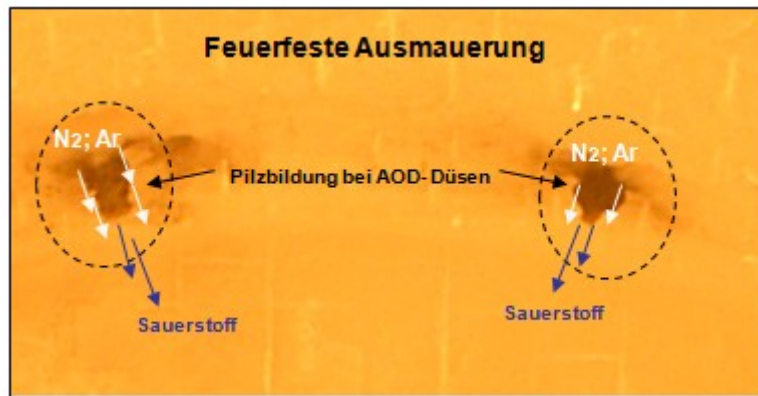
Abb. 48: Pilzbildung an den Düsenausgängen beim 180t AOD- CARINOX, IBN 2005.
