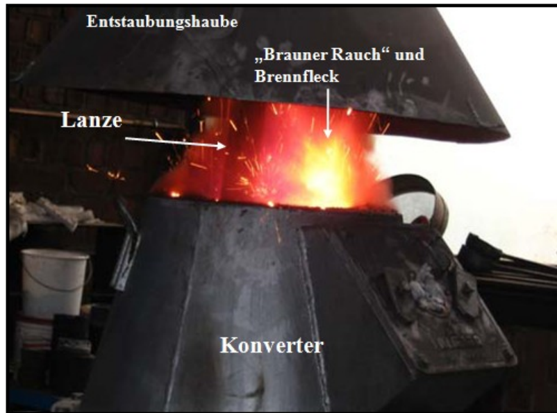
Abb. 95: „Brauner Rauch“ und Teile des Brennflecks während des ersten Versuchs.
