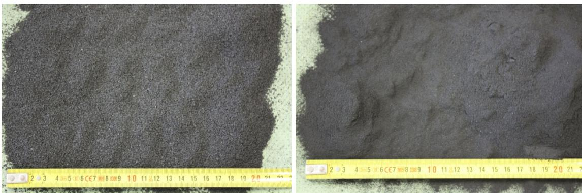
Abbildung 13-7: Stickstoffgekühlte Krätzproben: Kornfraktion 0,5–1 mm (li.) und < 0,5 mm (re.)
