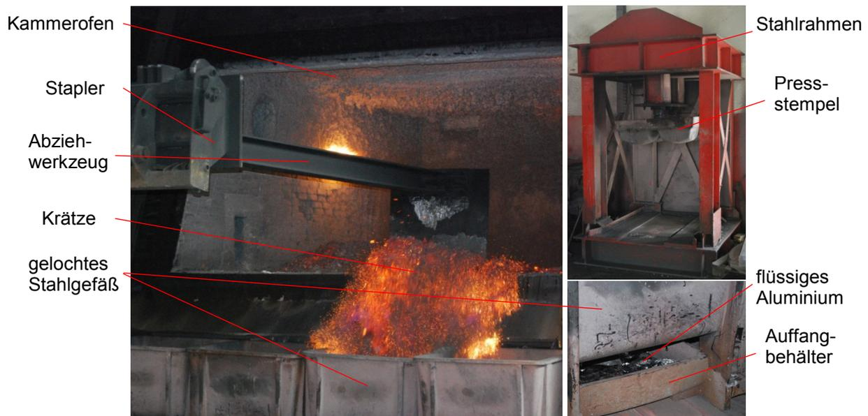
Abbildung 4-21: Abziehen der Krätze aus dem Kammerofen (li.) sowie Darstellung der Krätzepresse und des Auffangbehälters mit flüssigem Aluminium (re.)
