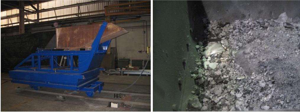
Abbildung 13-30: Darstellung der Chargiervorrichtung (li.) und vom Salzkuchen vermisch mit metallischem Aluminium (re.)
