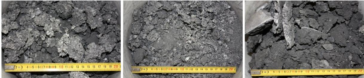
Abbildung 13-3: Darstellung des vorzerkleinerten Materials (manuell gepresst (li.), mit Stickstoff gekühlt (re.) und Block aus der Krätzepresse (re.))
