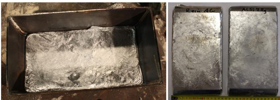
Abbildung 13-31: Darstellung der mit Aluminium gefüllten Form (li.) und der im Modell erstarrten Reinaluminium- sowie der AISi7Mg-Probe (re.)
