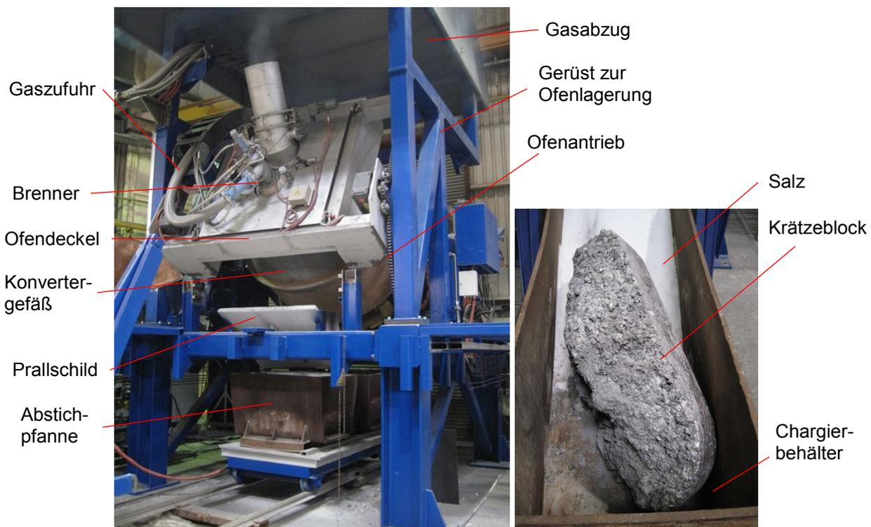
Abbildung 4-17: Darstellung des Kipptrommelofens im Homogenisierbetrieb (li.) sowie des Krätzepresslings mit dem Schmelzsatz in der Chargiervorrichtung (re.)
