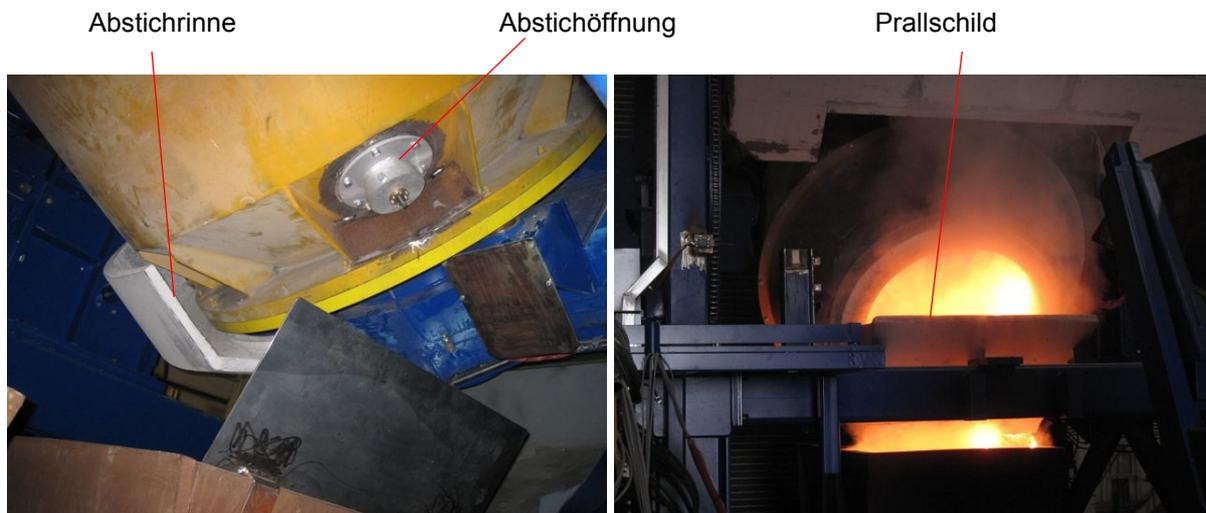
Abbildung 4-18: Darstellung der Abstichöffnung und -rinne für das flüssige Aluminium (li.) sowie der Entleerung des Salzkuchens (re.)
