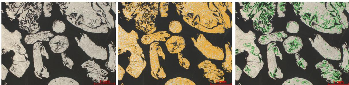
Abbildung 13-23: Kornfraktion 1–4 mm: Probe 1 der stickstoffgekühlten Krätze (Ausgangsmaterial (li.), metallische Phase (mi.) und Oxidanteil (re.))
