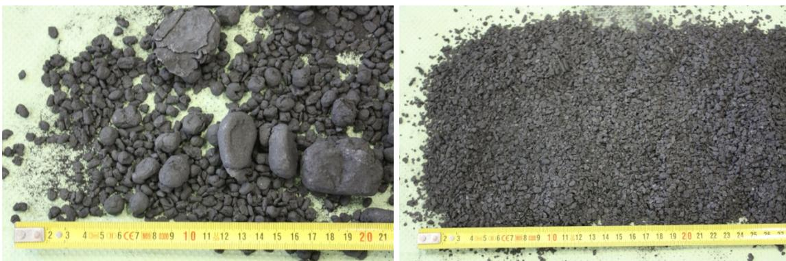
Abbildung 13-8: Manuell gepresste Krätzproben: Kornfraktion > 4 mm (li.) und 1–4 mm (re.)
