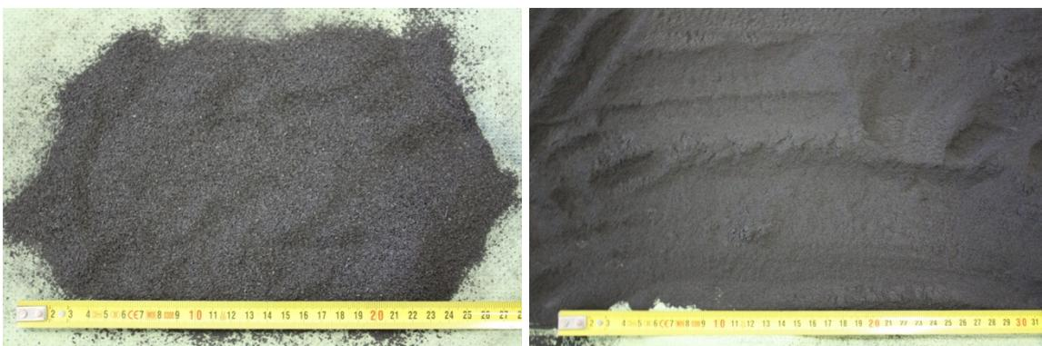
Abbildung 13-9: Manuell gepresste Krätzproben: Kornfraktion 0,5–1 mm (li.) und < 0,5 mm (re.)
