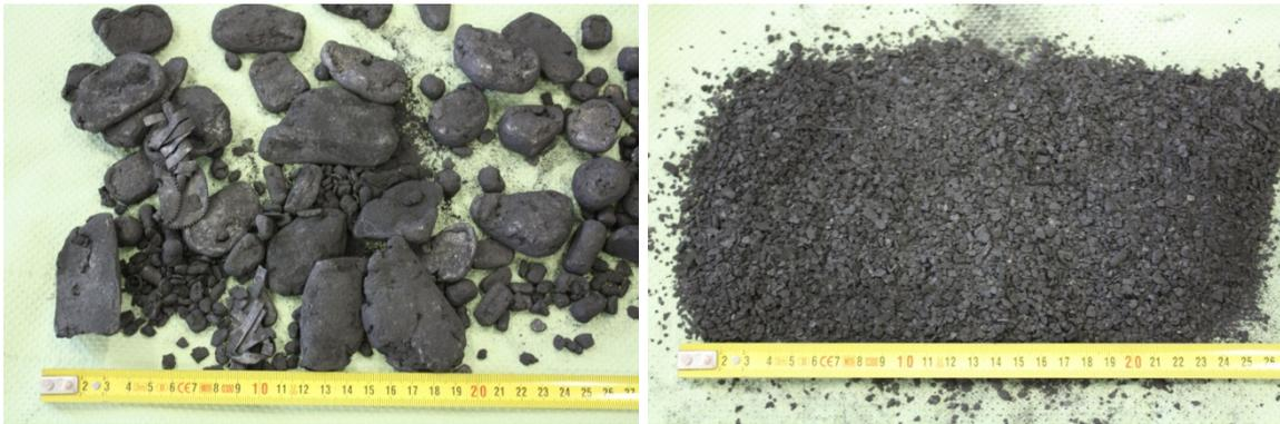
Abbildung 13-10: Maschinell gepresste Krätzeproben: Kornfraktion &gt; 4 mm (li.) und 1–4 mm (re.)
