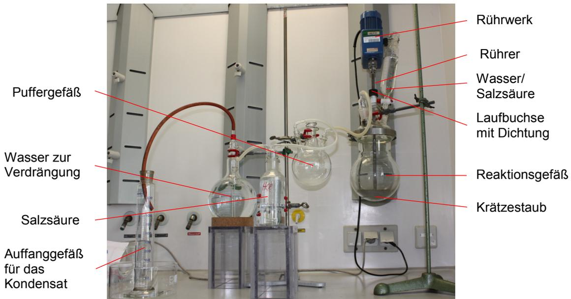
Abbildung 8-29: Versuchsaufbau zur Untersuchung des Gasbildungspotenzials
