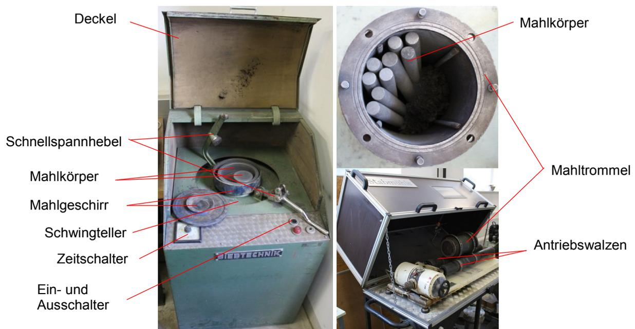
Abbildung 4-11: Darstellung der Schwingmühle (li) sowie der Stabmühle mit der Mahltrommel und den Mahlkörpern (re.)
