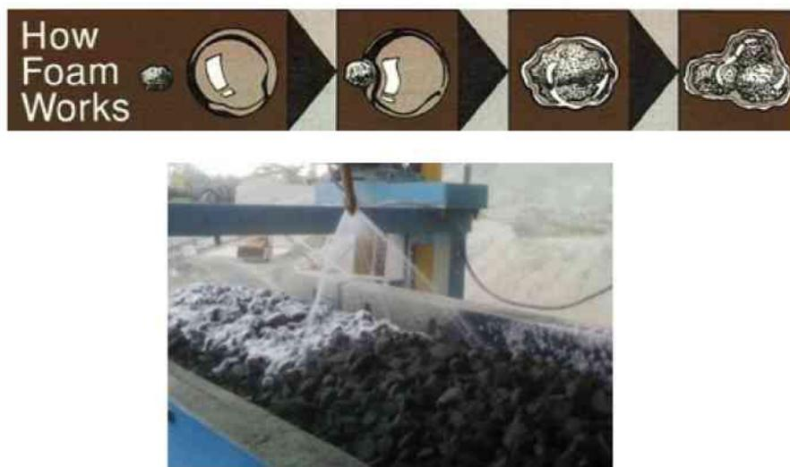
Abb. 2.26 Funktionsweise von staubunterdrückendem Schaum [16]
