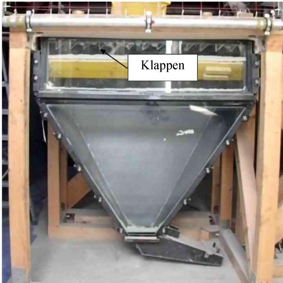
**Abb. 6.9 Klappensystem im Modellbunker**
