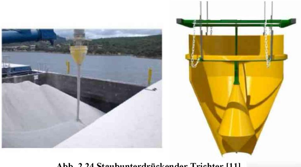
Abb. 2.24 Staubunterdrückender Trichter [11]
