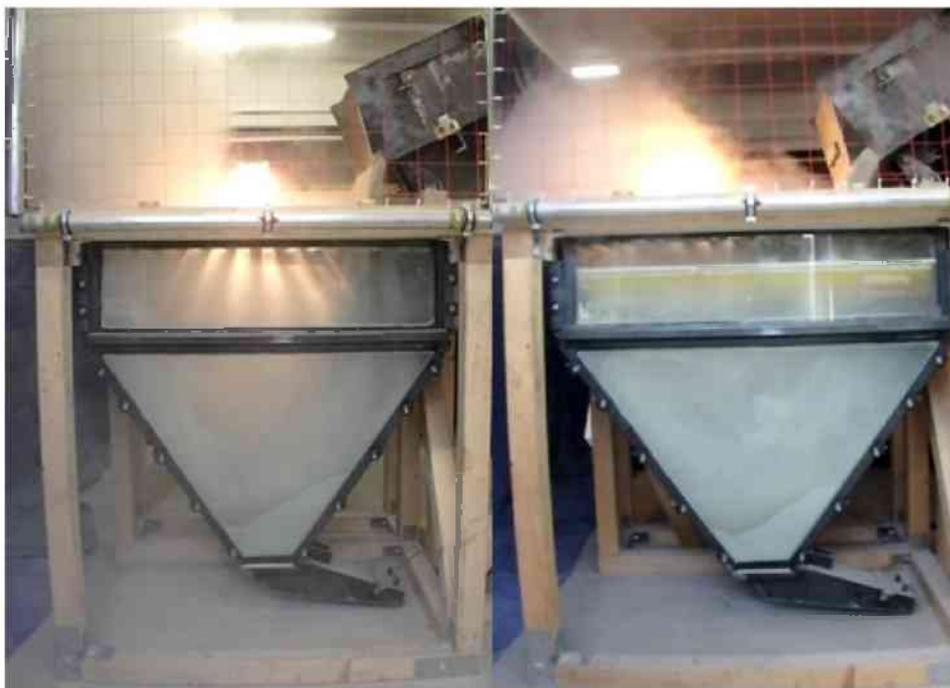
**Abb. 6.6 Vergleich Staubentstehung Standard (links) und mit Leitblech (rechts)**
