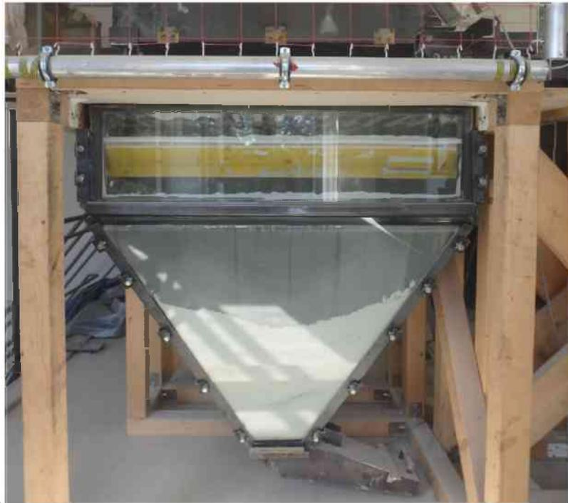
**Abb. 6.5 Versuchsbunker mit Leitblech**
