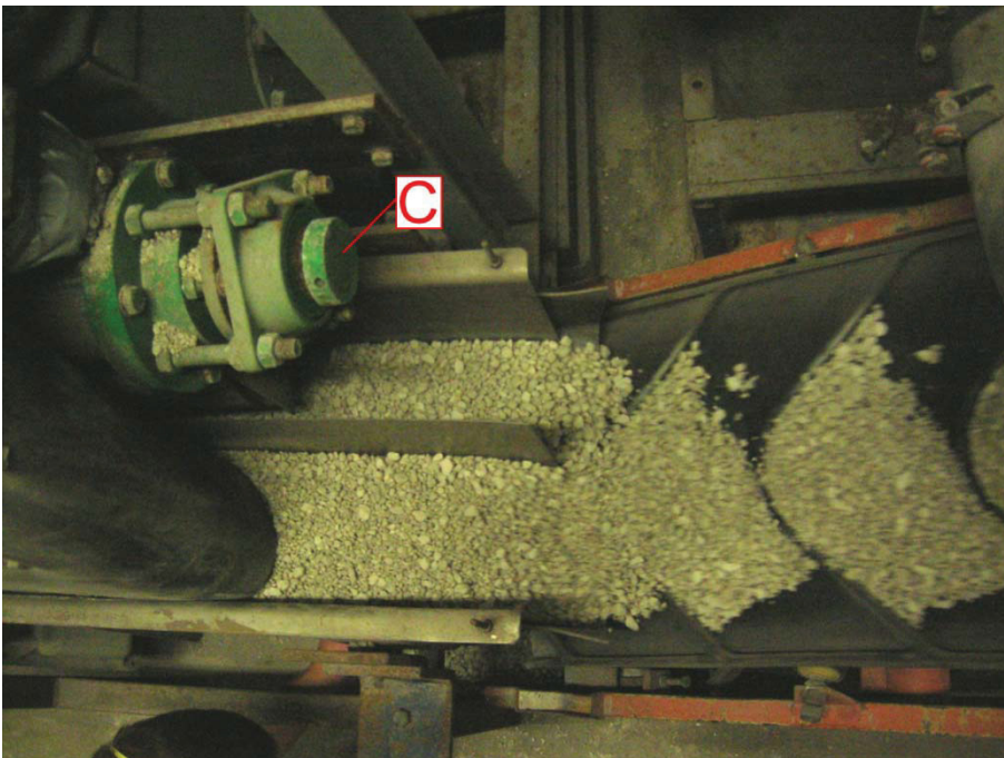
Abbildung 35: Austrag von Schwergut (oben) und Leichtgut (unten)
