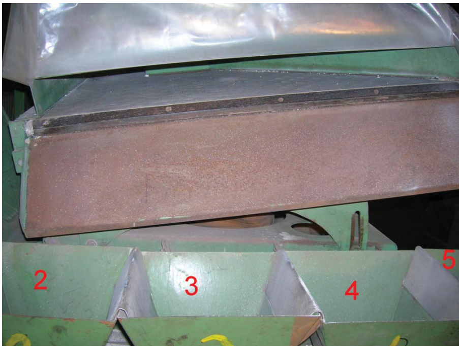
Abbildung 28: Blick auf die Herdplatte mit Austragschächten
