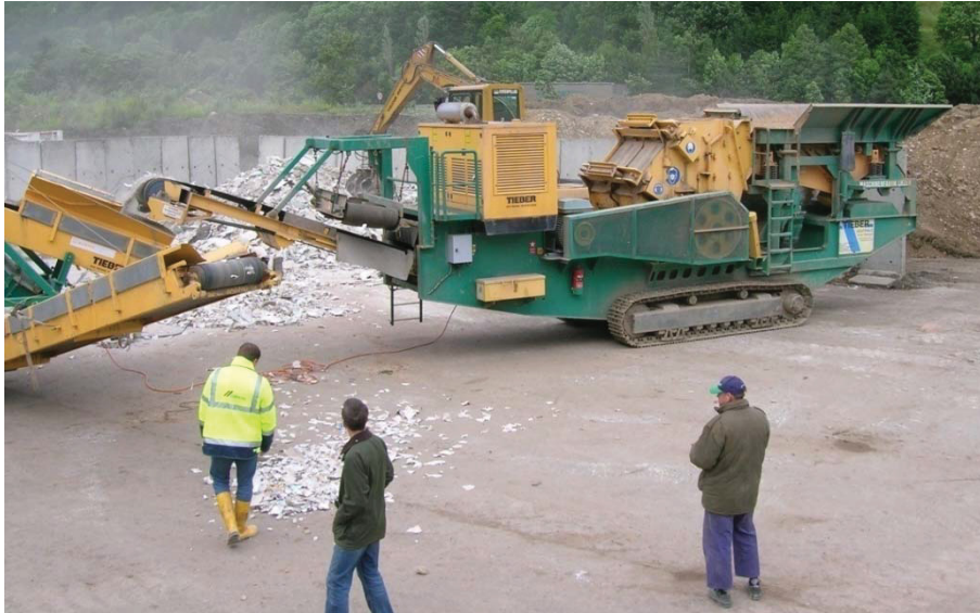
Abbildung 18: Prallbrecher (rechts) und Flächensieb (links)
