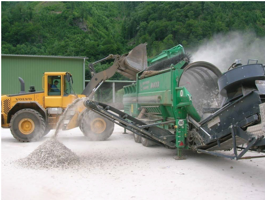
Abbildung 15: Beschickung des Trommelsiebes
