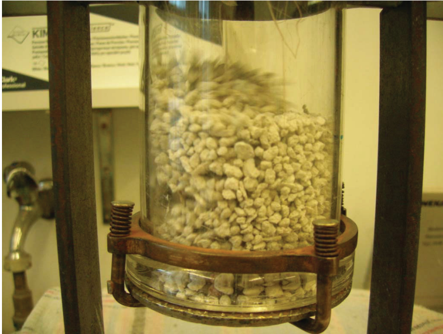
Abbildung 25: Probenbehälter mit durchwirbeltem Material
