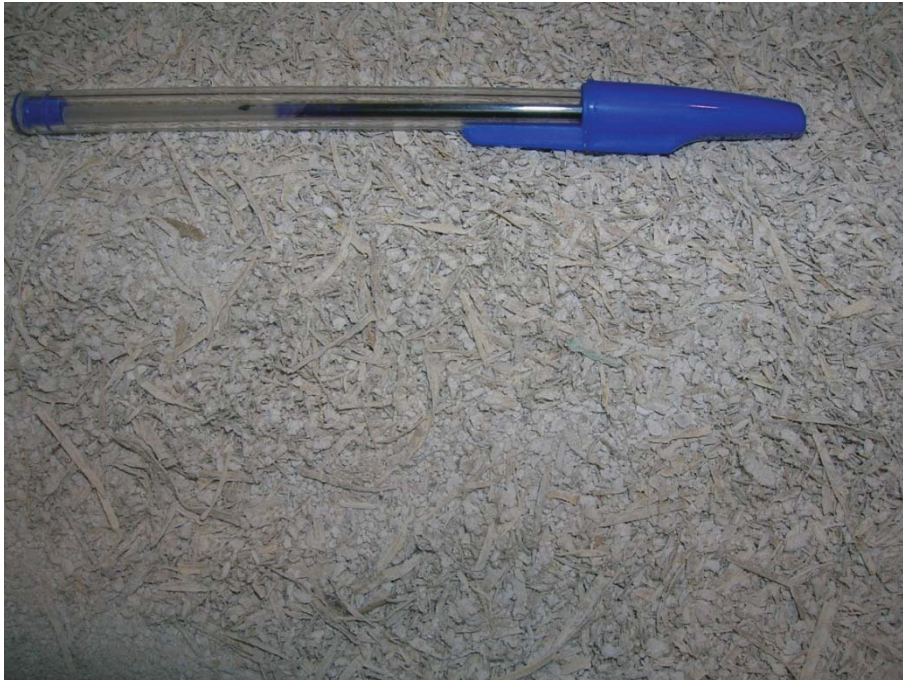
Abbildung 43: Durchgang der Siebung bei 2 mm
