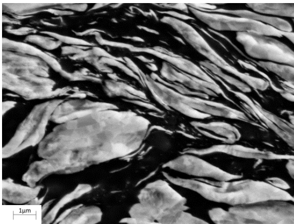
Abbildung 68: SE Aufnahme von HPT verformten W20Cu, 5 Umdrehungen mit einer Geschwindigkeit von 0,5 U/min, bei einem Radius von 8 mm, dies entspricht einem \gamma von 34
