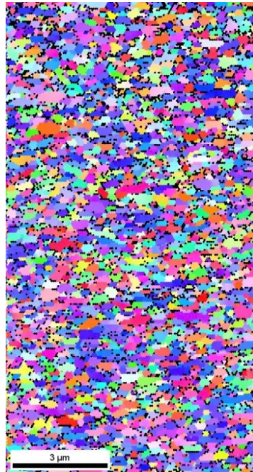
Abbildung 94: EBSD W 6U 450°C fast bei einem Radius von 4 mm, dies entspricht einem \gamma von 34
