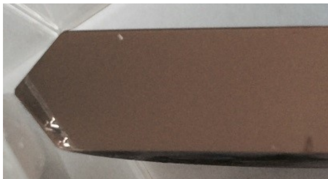
Abbildung 74: Metallographischer Schliff einer mit 20 Umdrehungen verformten HPT W20Cu Probe mit einer Geschwindigkeit von 0,07 U/min (slow)
