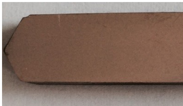
Abbildung 63: Metallographischer Schliff einer mit 5 Umdrehungen verformten HPT W20Cu Probe mit einer Geschwindigkeit von 0,5 U/min
