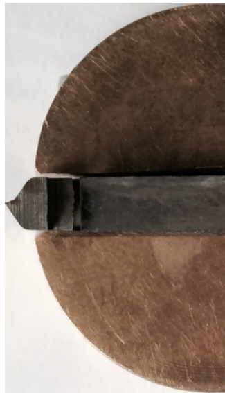
Abbildung 57: Metallographischer Schliff einer mit 6 Umdrehungen verformten HPT W Probe mit einer Geschwindigkeit von 0,5 U/min bei 450°C
