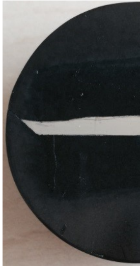
Abbildung 19: Metallographischer Schliff einer mit 5,25 Umdrehungen verformten HPT W Probe mit einer Geschwindigkeit von 0,5 U/min bei 400°C
