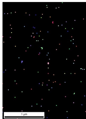
Abbildung 121: EBSD W20Cu 5U fast bei einem Radius von 10 mm, dies entspricht einem \gamma von 419
