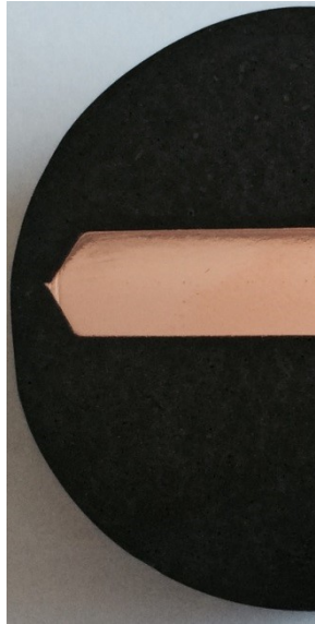
Abbildung 10: Metallographischer Schliff einer mit 10 Umdrehungen verformten HPT Cu Probe mit einer Geschwindigkeit von 0,5 U/min
