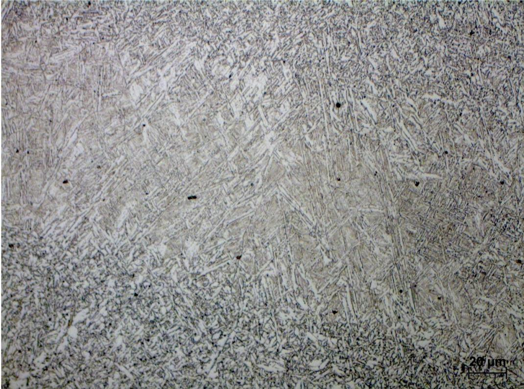
**Abb. 25:** LIMI-Aufnahme vom Detail X der Probe MVE (aus Abbildung 24) zeigt oben rechts und unten links globulare Körner und dazwischen eine nadelige Struktur.
