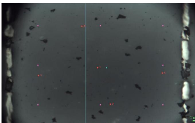
Abbildung 31: Fünf beliebig gewählte Messpunkte innerhalb einer Elektrode bei der Drehwinkelposition  $\theta = 0^\circ$
