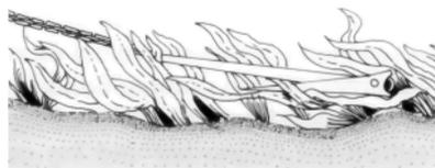
Abb. 2.28: Verkrauteter Boden; Anker dringt nicht zum Grund durch und fasst nicht [50, S. 26]
