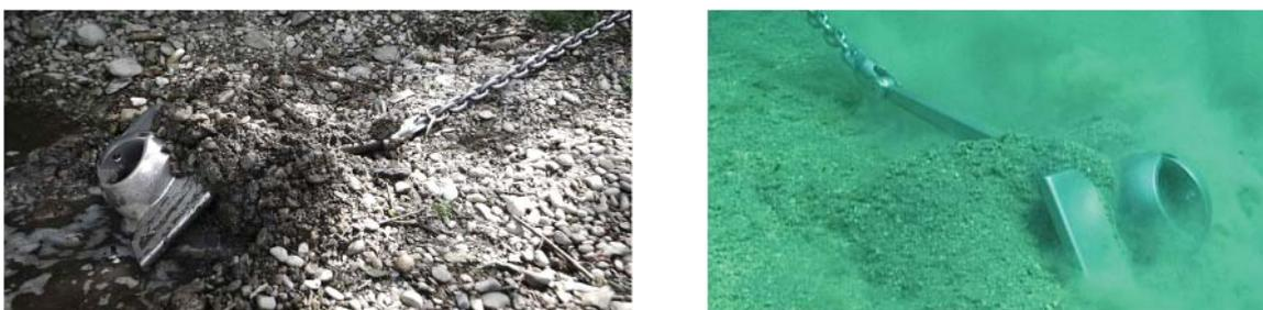
Abb. 2.55: Feldtest des Seahawk: Schottergrund an Land (li.) und sandiger Ankergrund unter Wasser (r.) [29]
