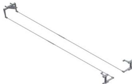
Abb. 5.39: Hebelmechanismus der Wippensperre
