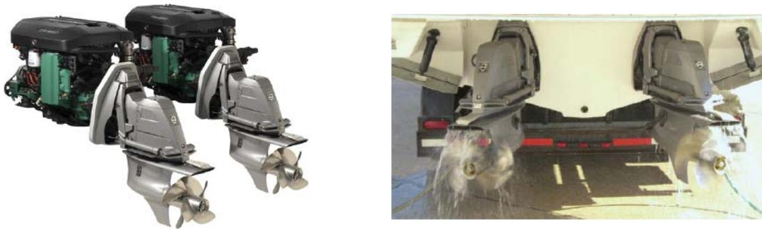
Abb. 2.7: Volvo Penta Aquamatic, Doppel-Z-Antrieb [9, 39]
