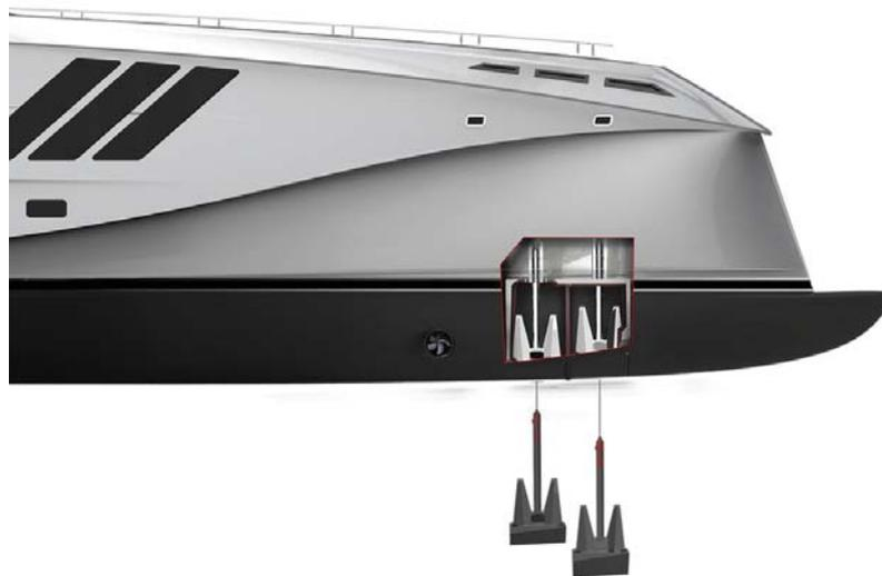
Abb. 2.75: *Palmer Johnson SuperSport*, Unter-Wasser-Ankersystem [43]
