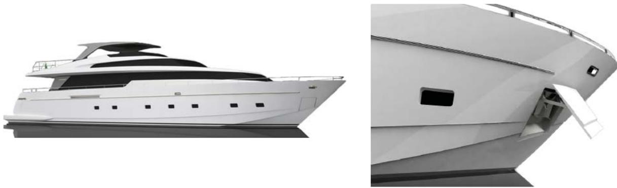
Abb. 2.71: Sanlorenzo SL100 New mit abdeckbaren Ankertaschen, geschlossen (li.) und geöffnet (r.) [53]
