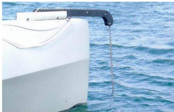
Abb. 2.74: Ausklappender Arm, beispielsweise für Pflugscharanker [60]
