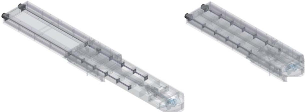
Abb. 5.24: Position der beiden Spindeltriebe in der Ankerlade bei aus- (li.) und eingefahrener (r.) Lade
