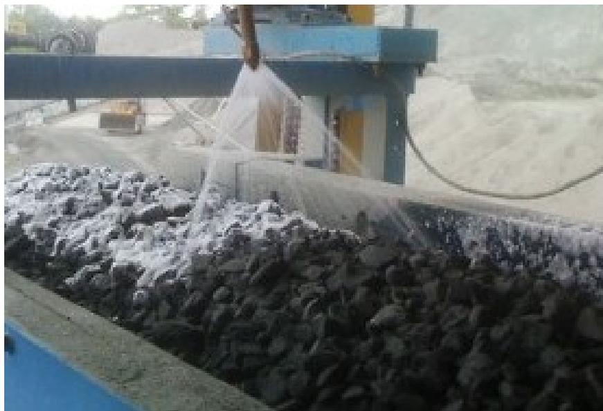
Abbildung 23: Funktionsweise von staubunterdrückendem Schaum [8]
