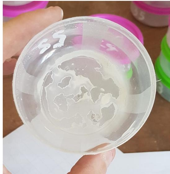
**Abbildung 52: Aufgetrocknete Messdose**
