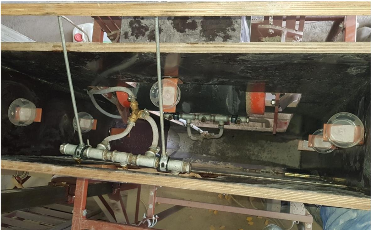
**Abbildung 50: Eingebaute Sprühbalken**
