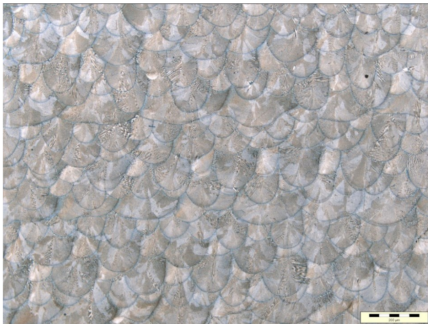
Abbildung 27: Schliffbild Probe 2.01 - geätzt mit Kailling
