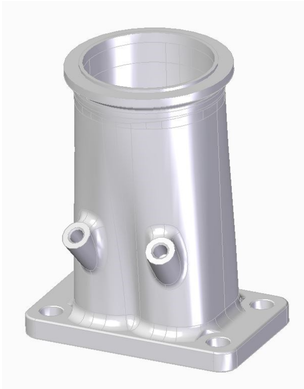
Abbildung 25: Verbindungsstück für Auspuffrohr Inconel718
