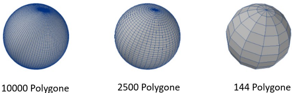
Abbildung 5: Kugel mit unterschiedlich vielen Polygonen [28]
