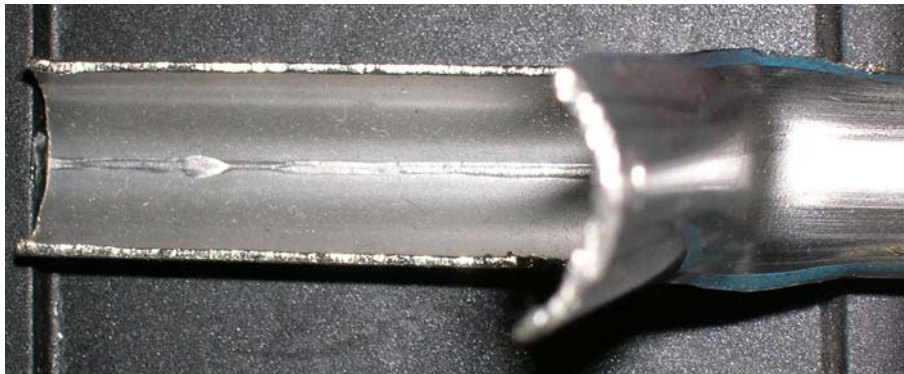
Abbildung 7.2-1: Schweißnahtfehler / Nicht durchgeschweißt / Typ B (automatisierte Prüfeinrichtung)
