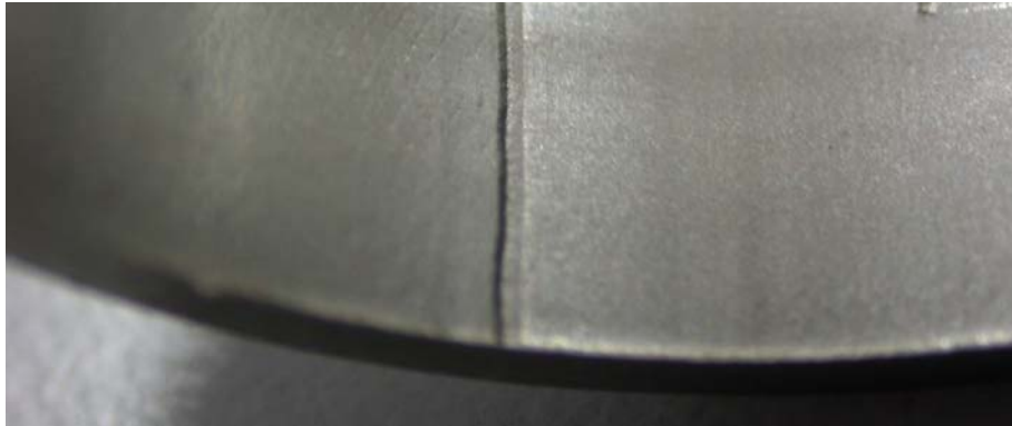
Abbildung 7.2-6: Glättung nicht in Ordnung / Schlechte Glättung (ungleichmäßige Verdrängung des Werkstoffs im Wurzelbereich – „Kante“) / Typ B (automatisierte Prüfeinrichtung)
