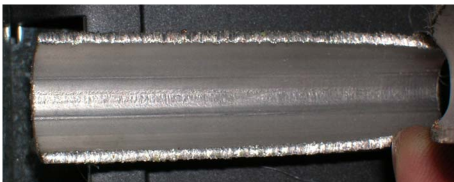
Abbildung 7.2-6: Schweißnahtfehler / Spannungsriss (Erstarrungsriss aus Heißrißneigung von Edelstählen und überlagerten Rückstellkräften) / Typ B (automatisierte Prüfeinrichtung)
