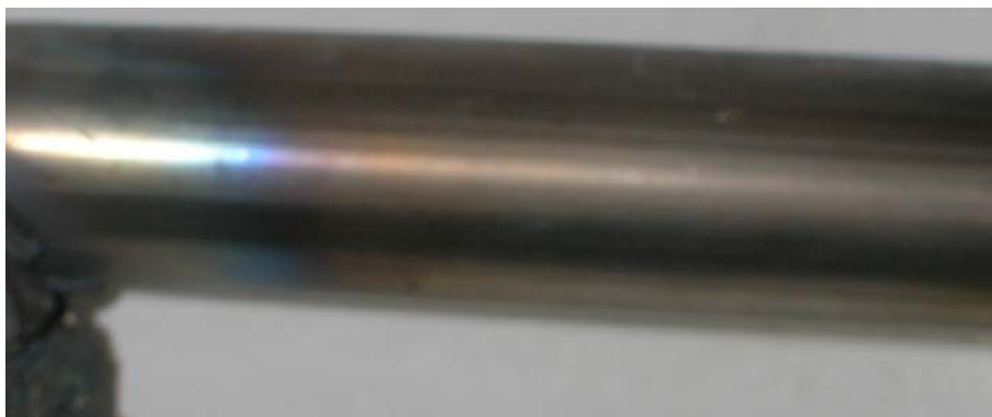
Abbildung 7.2-8: Anlauffarbe (Kontakt des Glühguts mit atmosphärischen Gasen) / Typ A (Selbstkontrolle Anlagenbediener)
