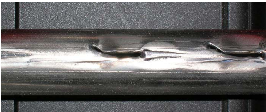
Abbildung 7.2-3: Schweißnahtfehler / Schweißaussetzer (Durchfall des Schmelzbades) / Typ B (automatisierte Prüfeinrichtung)
