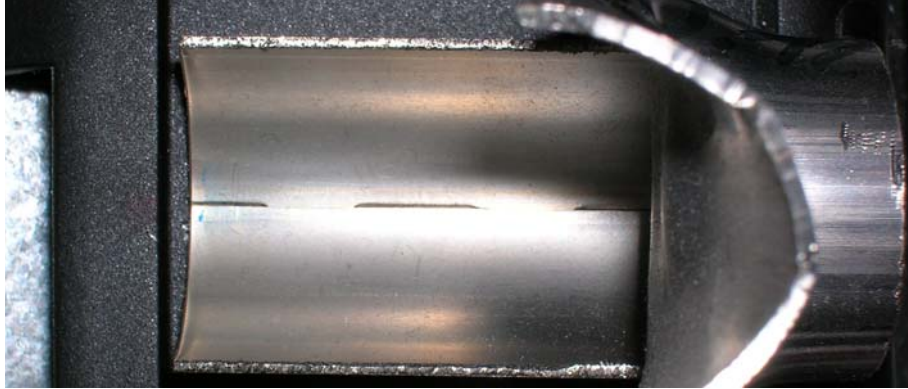
Abbildung 7.2-4: Schweißnahtfehler / Kantenversatz (geglättete Ausführung) / Typ B (automatisierte Prüfeinrichtung)
