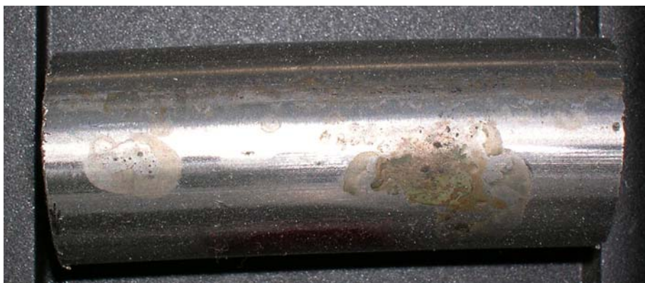
Abbildung 7.2-10: Oberflächenfehler innen / außen / Glüherflecken (Verunreinigungen die im Zuge der Glühbehandlung auf die Rohroberfläche aufgebracht werden) /Typ A (Selbstkontrolle Anlagenbediener)
