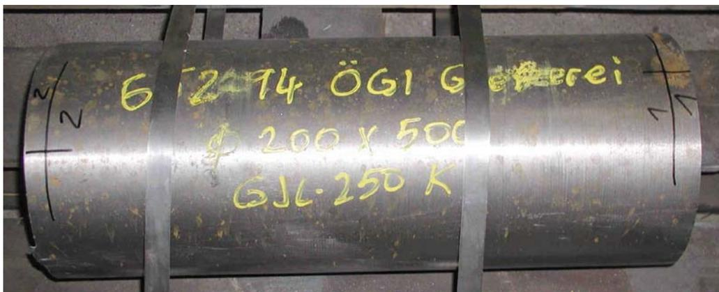
**Bild 58:** Kokillengussbarren mit einem Durchmesser von 200 mm
