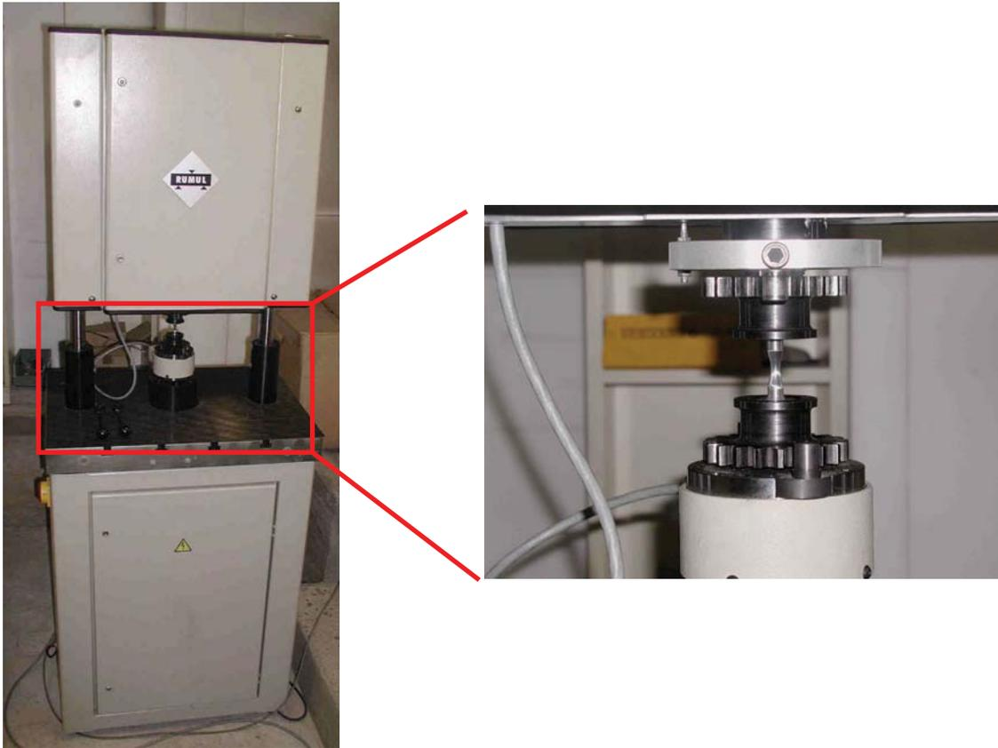
**Bild 72:** 30 KN – Hochfrequenzpulsator, Mikrotron, der Firma Russenberger Prüfmaschinen AG
