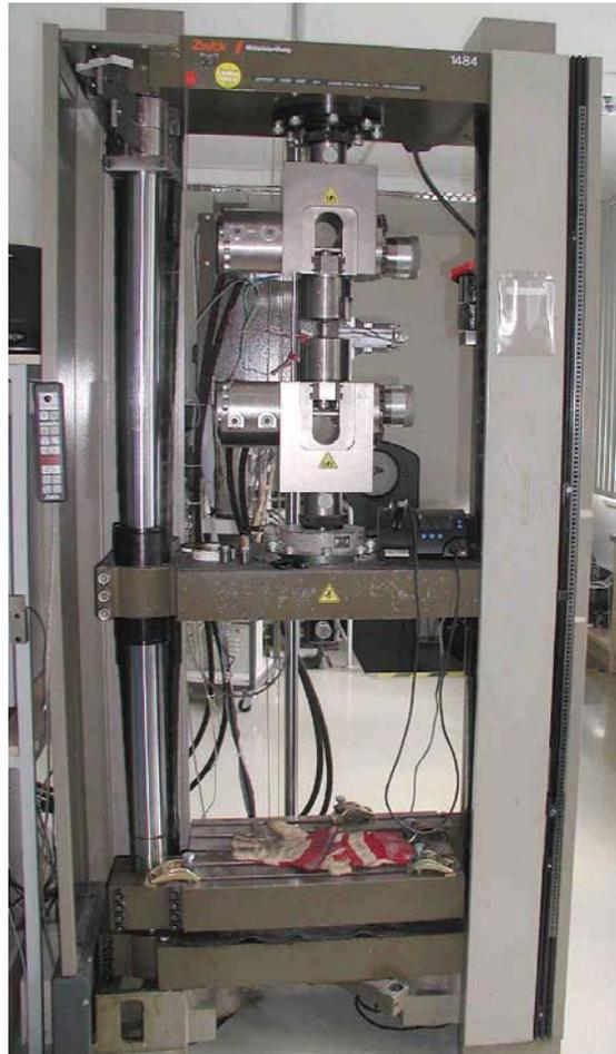
**Bild 67:** Universalprüfmaschine ZWICK 1484, 200 KN
