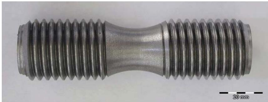
**Bild 68:** Profilierte Zugprobe, Form A, 20 mm Prüfdurchmesser, nach EN 1561 [32]
