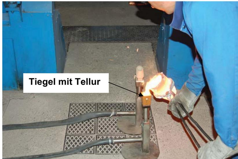
**Bild 49:** Thermische Analyse zur C und Si Bestimmung, Tiegel mit Te
