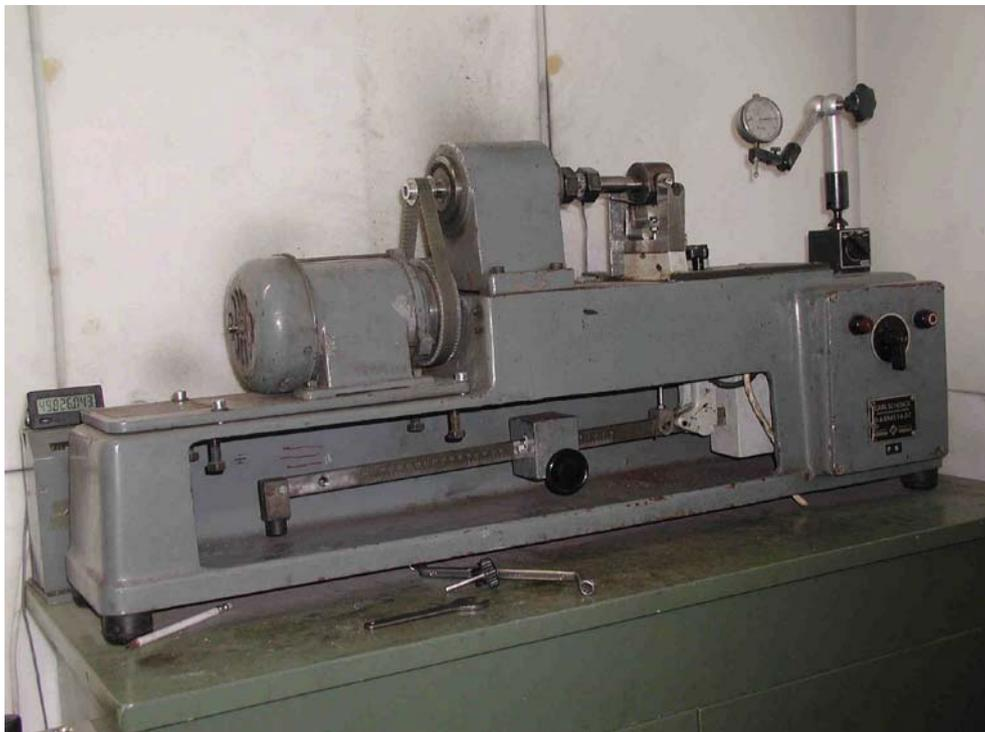
**Bild 76:** Umlaufbiegemaschine der Firma Carl Schenk
