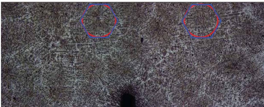
**Bild 64:** Bestimmung der eutektischen Kornzahl mittels Kreismethode
