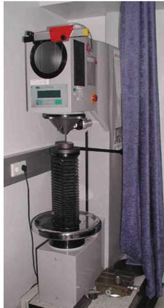
**Bild 56:** Universalhärteprüfer EMCO TEST M5U-030 der Firma EMCO TEST Prüfmaschinen GmbH
