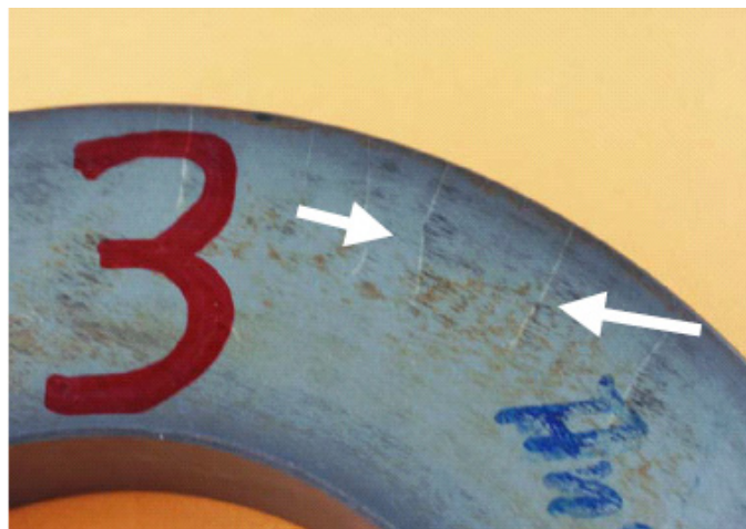
Abbildung 51: Beginnende Absplitterungen in der Oberwalze des Walzringpaares 5.
