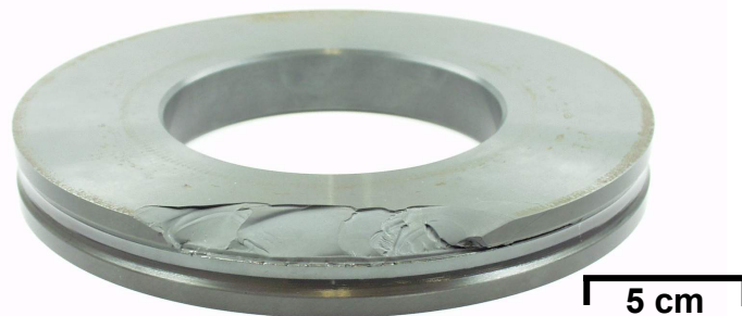
Abbildung 52: Walze 2 des Walzringpaares Nr. 2 mit großer Absplitterung. In der Walzspur ist ein umlaufender Riss erkennbar.
