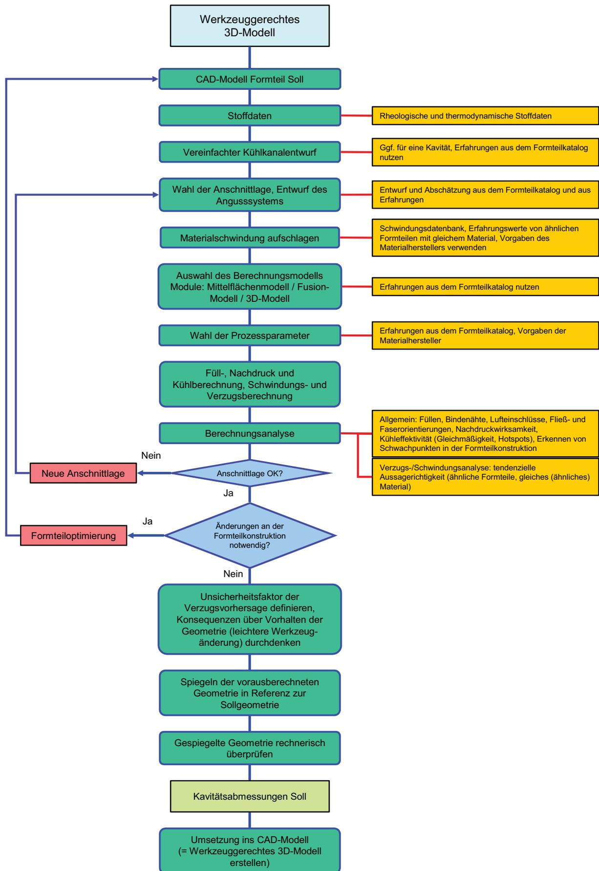
Bild 91: Flussdiagramm des Programmmoduls „Werkzeuggerechtes 3D-Modell“
