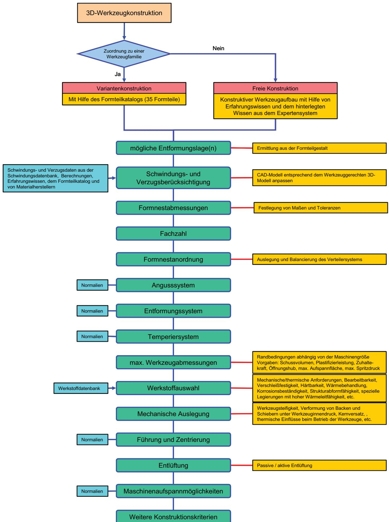
Bild 92: Flussdiagramm des Programmmoduls „3D-Werkzeugkonstruktion“
