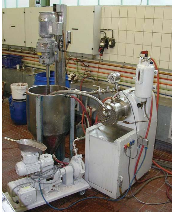
Abbildung 6-66: Zirkulationsmühle LMZ 2 im Kreislaufbetrieb
