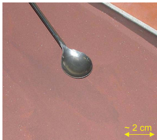
Abbildung 6-21: Vorsinterprodukt (Leistungsferrit) aus dem Pulsationsreaktor bei 950 °C
