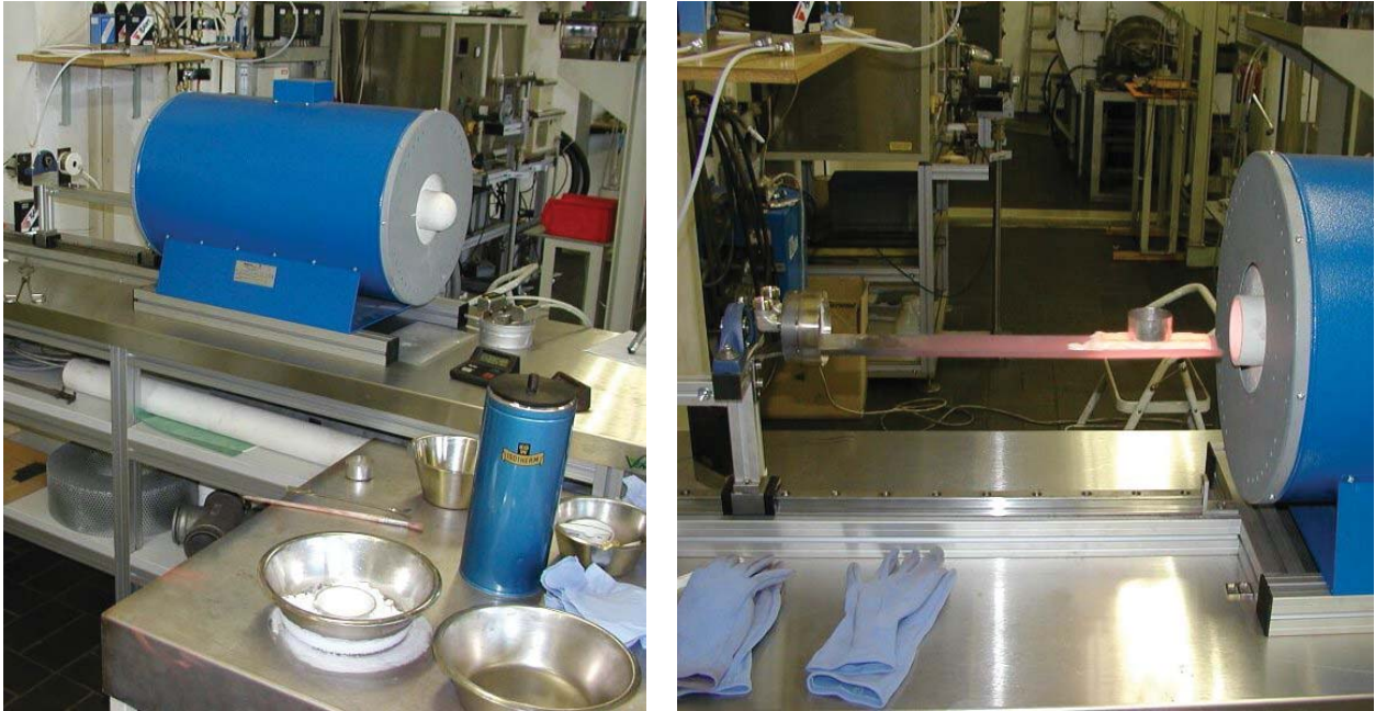
Abbildung 4-4: Rohrofen der Fa. Linn im Technikum der voestalpine Stahl GmbH, CO 2 -Schnee zum Abschrecken der Probe, Einfahren der Probe in das Rohr
