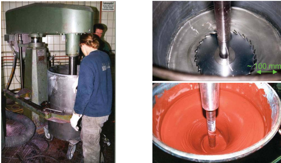
Abbildung 6-6: Darstellung des Dispersers, Blick auf die Dispergierscheibe und einen Ansatz nach Zugabe sämtlicher Komponenten
