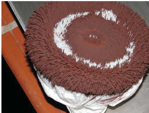
Abbildung 6-16: Ausrichtung von Vorsinterprodukt an den Feldlinien eines Lautsprecherringmagneten
