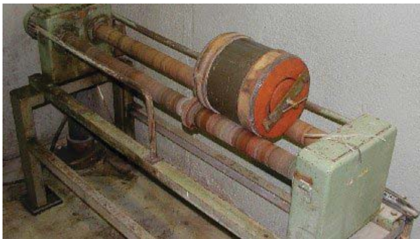
Abbildung 3-22: Trommel zum Herstellen eines homogenen Schlickers mit definiertem Wassergehalt für die Sprühgranulation
