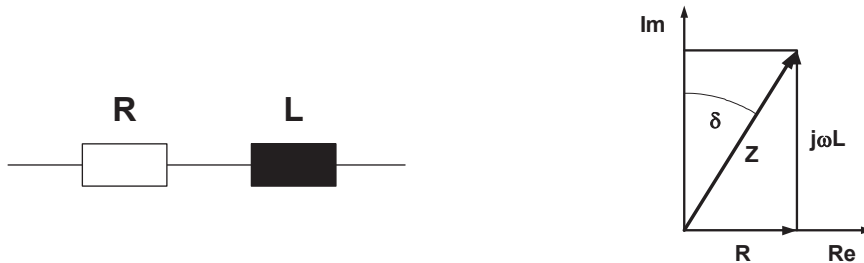
Abbildung 2-35: Ersatzschaltbild für eine reale Spule und Darstellung der Impedanz Z in der Gaußschen Zahlenebene
