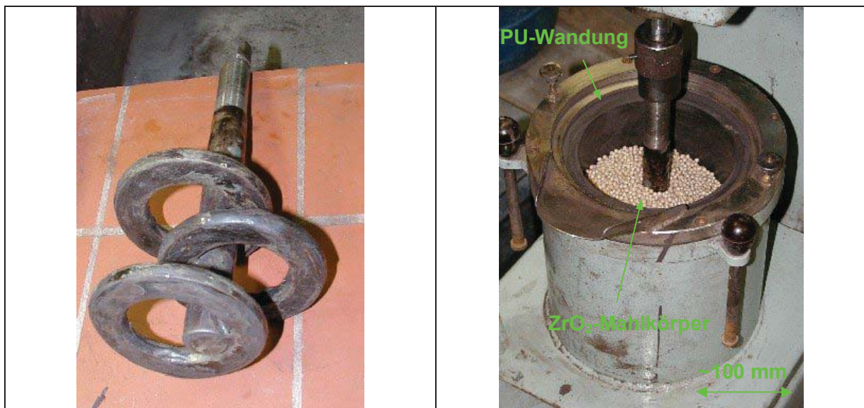
Abbildung 3-20: Polyurethanbeschichtetes Rührwerk bzw. Attritor mit PU-Beschichtung und \text{ZrO}_2 Kugeln gefüllt
