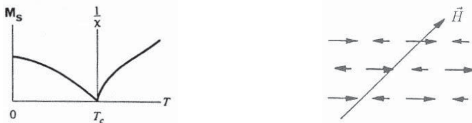
Abbildung 2-13: Charakteristika ferrimagnetischer Stoffe [3]
