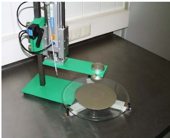
Abbildung 5: Liftomatgerät bei der Messung
