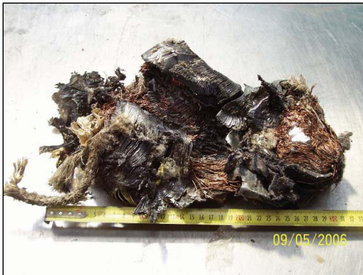
Abbildung 49: Trafospule mit Kupfer, KW 19
