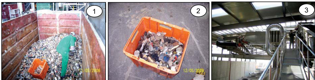
Abbildung 27: Störstoffe aus Schwer/Leicht-Trennung (1), Störstoffe im Detail (2), Windsichter (Schwer/Leicht-Trennung) zur Störstoffabtrennung (3)
