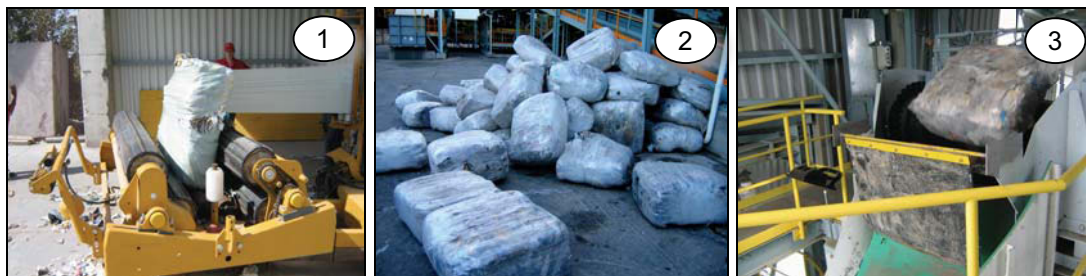
Abbildung 77: Folierung durch mobile Ballenfoliermaschine (1), folierte Ballen (2), Ballen am Förderband zur HOTDISC (3)
