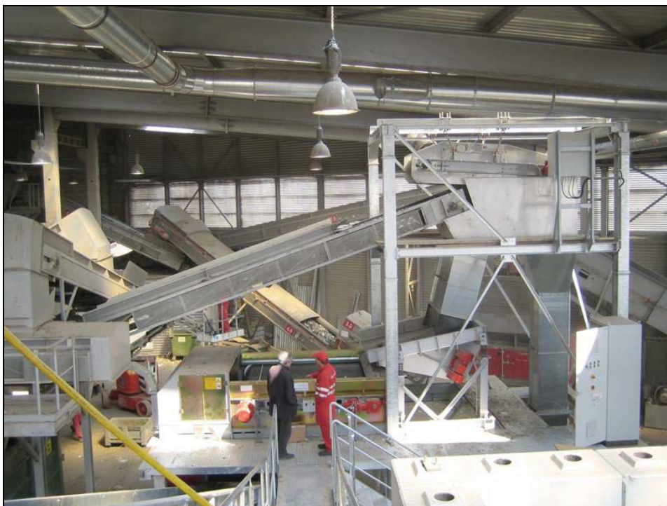
Anhang-Abb. 37: Überband Magnetabscheider (Fe Schrott) und Wirbelstromscheider (NE)
