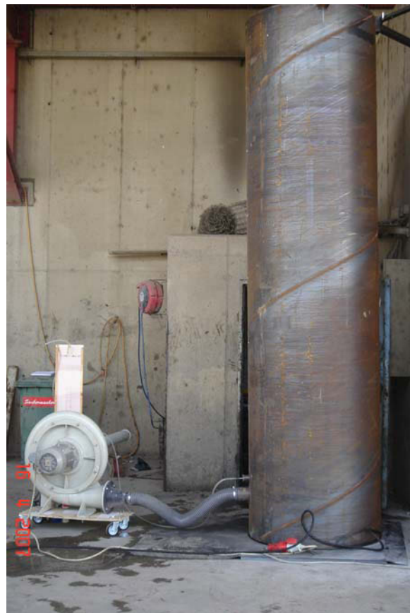
Abbildung 24: U-Rohr, Gebläse und Hohlzylinder mit Zuleitung zur Bestimmung der Permeabilität
