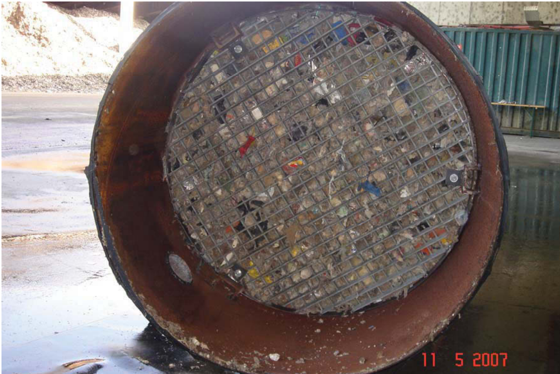
Abbildung 25: Ansicht des befüllten Hohlzylinders von der beströmten Seite nach Umlegen der Versuchsanlage
