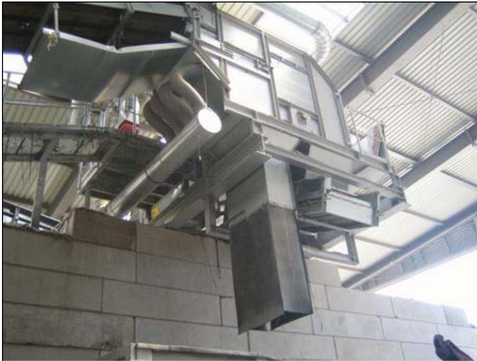
Anhang-Abb. 38: Windsichter (Störstoff-Abscheider)
