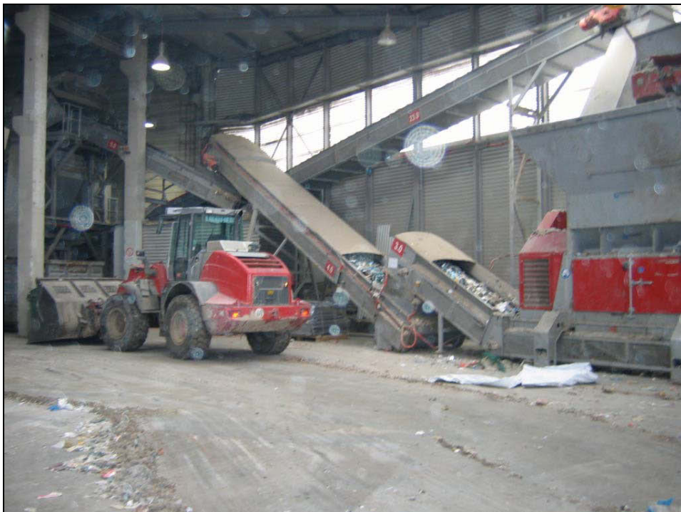
Anhang-Abb. 43: Vorzerkleinerer Lindner Jupiter mit Rückföhrband (Kreislaufzerkleinerung), im Hintergrund Magnetabscheider und Kreisschwingsieb (80 mm)
