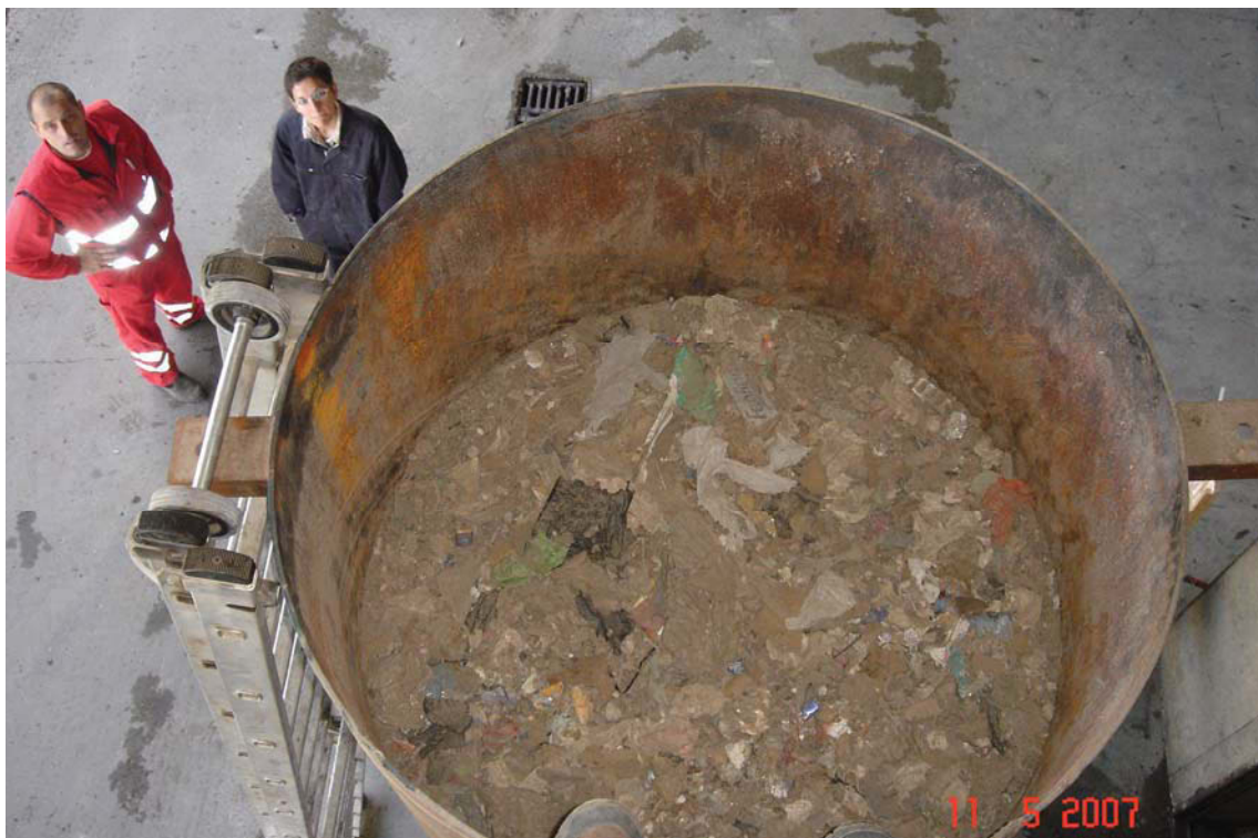
Abbildung 28: Nach 3 Wochen Lagerung setzte sich die Schüttung um 54 cm
