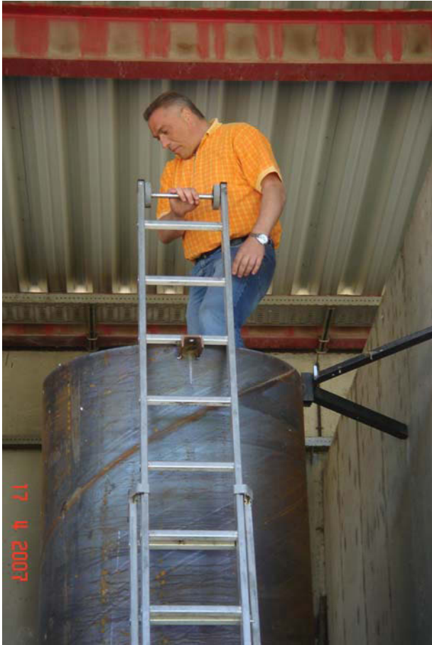
Abbildung 29: Beispiel der mechanischen Verdichtung; zeigt auch die Verankerung an die Wand
