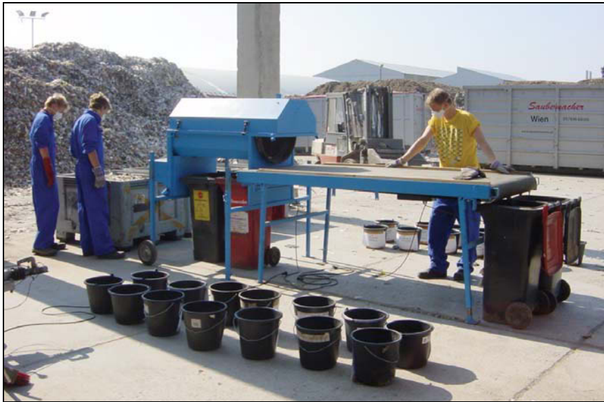
Anhang-Abb. 2: Aufstellung des Trommelsiebes und des Sortierbandes mit den Probenbehältern im Hintergrund und den Fraktionsbehältern am Boden
