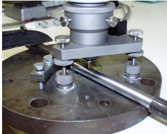
Fig. 2: Hole drilling rig.
