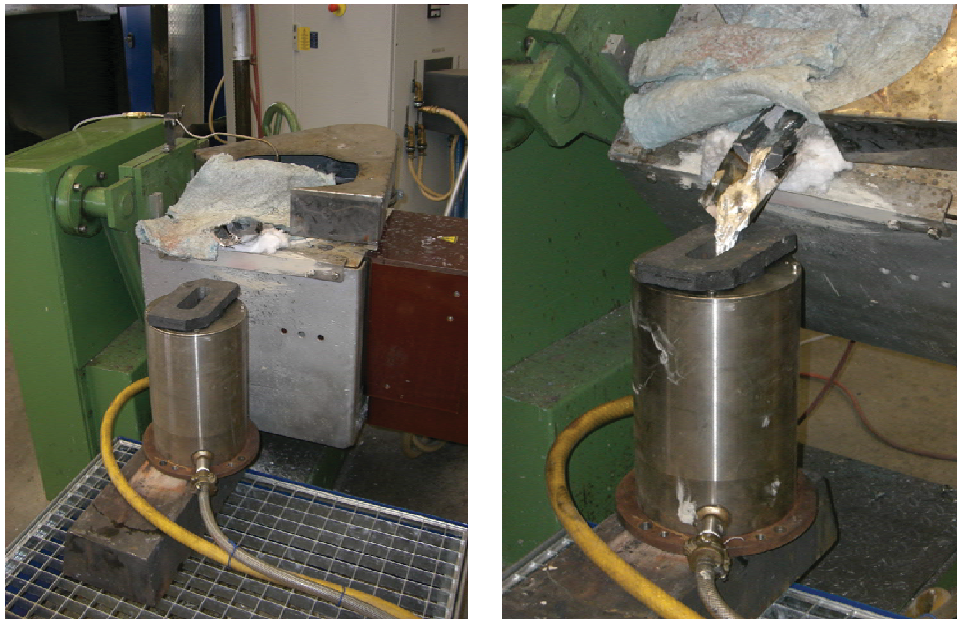
Abbildung 6-1: ITG Induktionsofen und wassergekühlte Kokille am Institut für Nichteisenmetallurgie (links) und Versuchsgießen von AA5083 (rechts).
