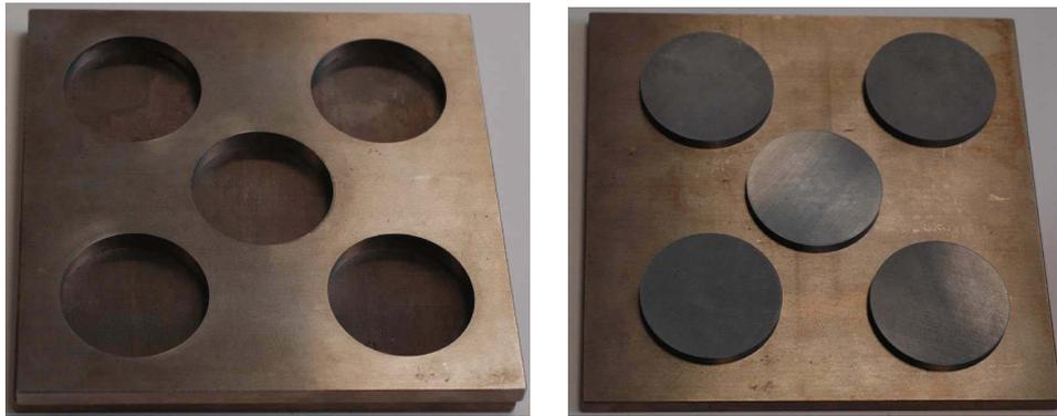
Bild 46: Pressenwerkzeug: links: untere Deckplatte und Matrizenplatte, rechts: obere Deckplatte und Distanzscheiben.
