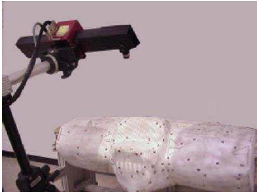
*Bild 87: Digitalisierung eines mit Titandioxid besprühten Objektes. Die Referenzmarken (schwarz) sind auf dem Objekt aufgeklebt [46].*
