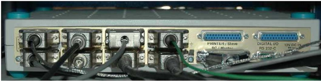
Bild 32: Rückseite des Messdaten-Erfassungssystems Spider8 mit den 8 verfügbaren Kanälen für analoge Eingangssignale (links).
