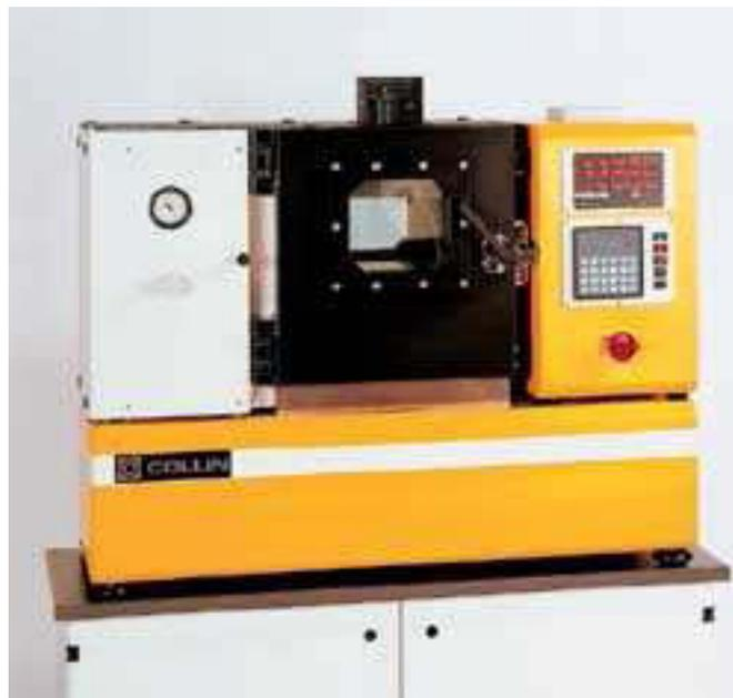
*Bild 45: Vakuumpresse P 200 PV der Firma Dr. Collin GmbH (Ebersberg / Deutschland) für die Probenherstellung.*
