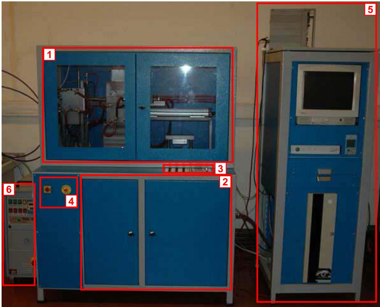
*Bild 26: Gesamtansicht der hcr-pvT-Apparatur (Vorderseite):*
