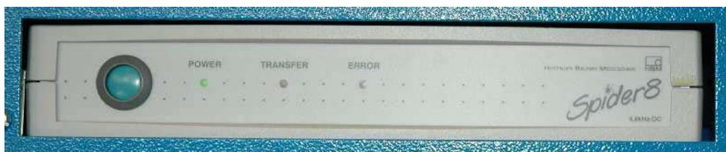
Bild 31: Vorderseite des Messdaten-Erfassungssystems Spider8.
