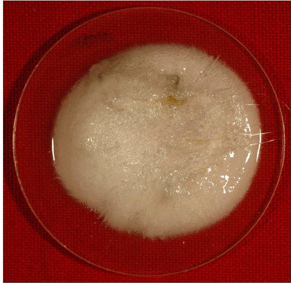
*Bild 47: Blasenbildung nach dem Aufheizen einer Probe aus Polycarbonat, welches nicht vorgetrocknet wurde.*
