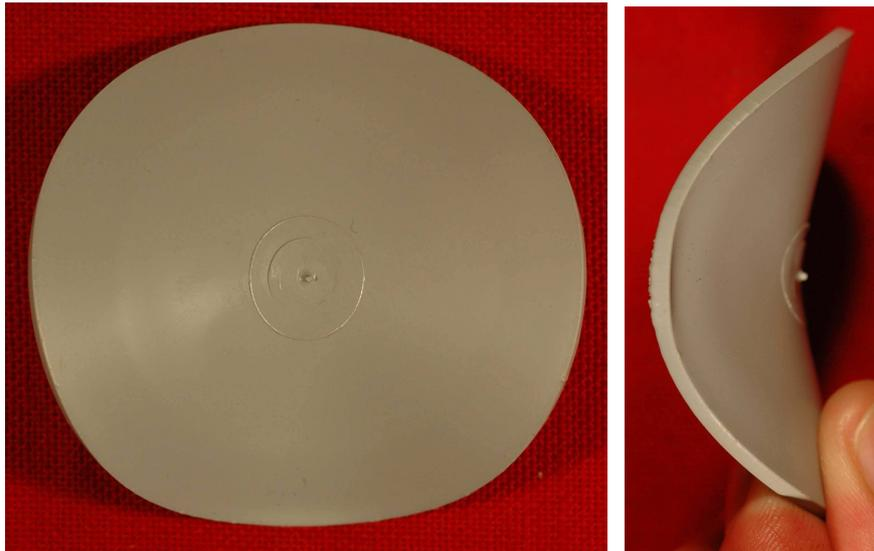
*Bild 43: Deformation einer spritzgegossenen Kunststoffprobe aus ABS (Urtal M122 von Enichem Polimeri) nach dem Aufheizen auf 230°C im Wärmeschrank (Probendicke = 2,3 mm) [10].*
