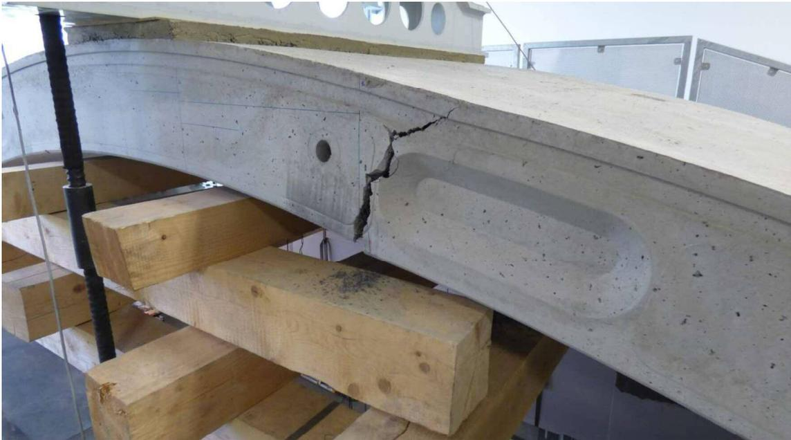
Abbildung 60: Außermittiger Riss bei Versuch 22
