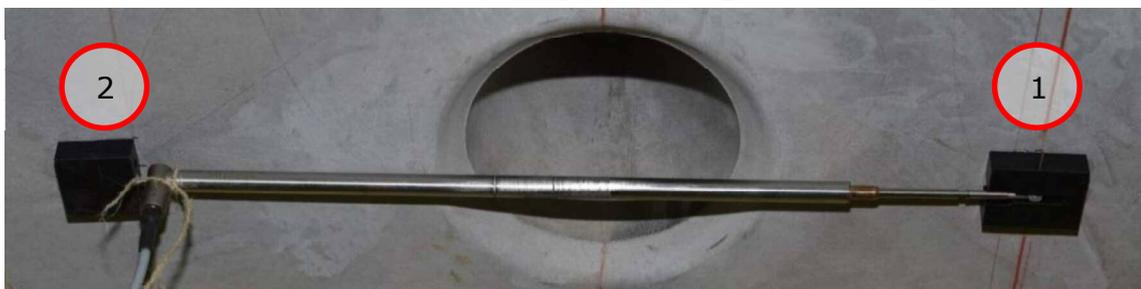
Abbildung 25: Befestigung des LVDT's am Tübbing
