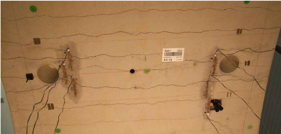
*Abbildung 47: Rissbild am Intrados nach Versuchsdurchführung bei Versuch 1*
