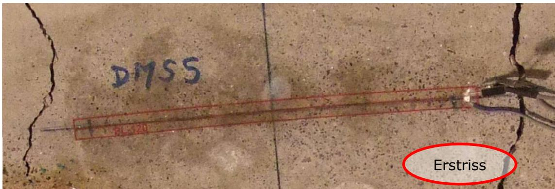
Abbildung 35: Risspositionen nach dem Versuch bei DMS 5 bei Versuch 1
