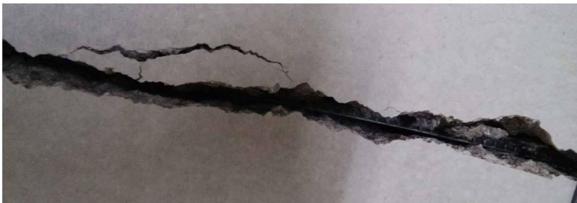
*Abbildung 31: Exemplarische Rissentstehung an der Position eines Quereisens bei Versuch 16*
