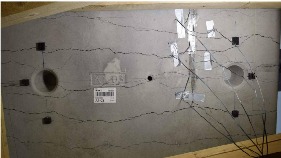
*Abbildung 48: Rissbild am Intrados nach Versuchsdurchführung bei Versuch 15*
