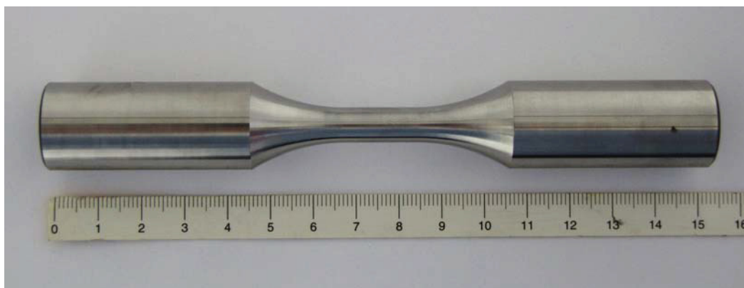
Abbildung 4.5: LCF Probenform für Druckversuche
