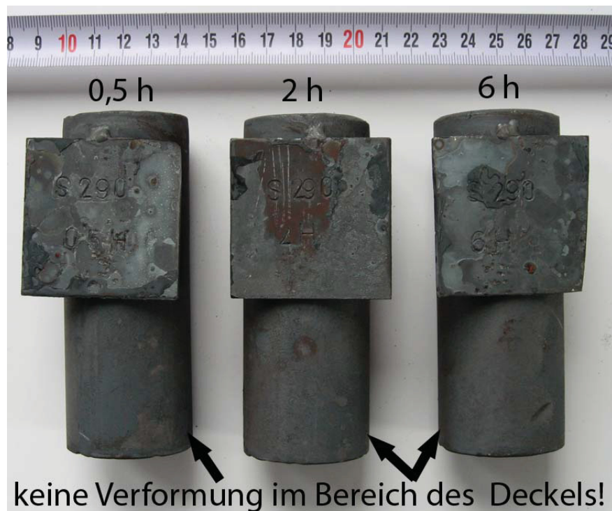
Abbildung 5.26: Fingerkapselvergleich der für 0,5-2-6 h nitrierten S290 PM Pulver nach dem Hippen
