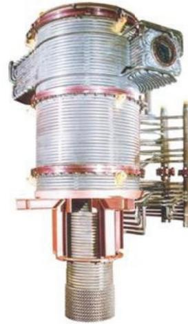
Abbildung 17: CONTOP®-Schmelzzyklon<sup>[25],[26],[84]</sup>
