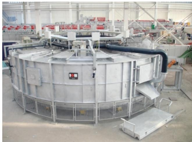
Abbildung 11: Verfahrensschema und Anlagenkonstruktion eines Drehherdofens<sup>[84]</sup>
