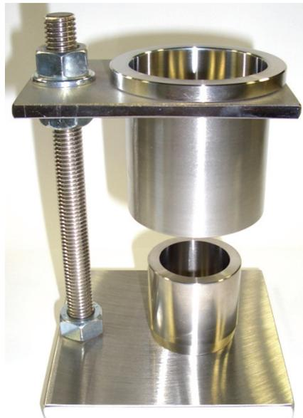
Abbildung 24: Schüttdichtemessgerät nach EN 23923-1
