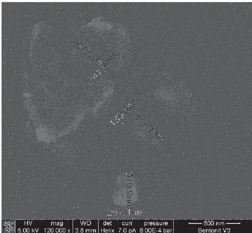
Abb. 49.3 ESEM Aufnahme (V3) Schichtpakete aus sehr kleinen Lamellen
