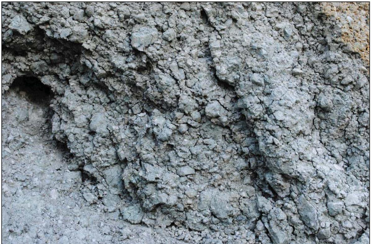
Abb. 10.3 Bentonitstruktur in „Agheria“ am Stoß: Brecken- Tuffe
