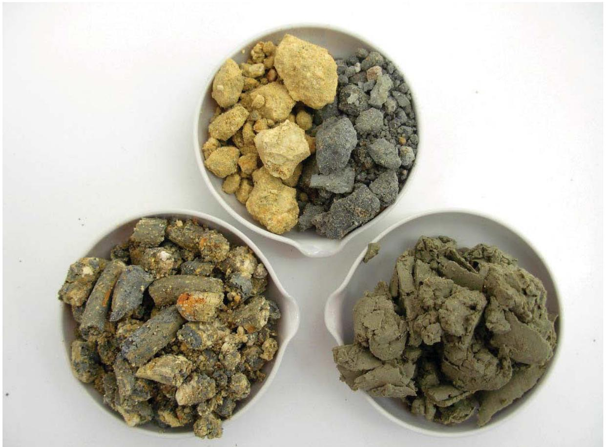
Abb. 16 Struktur- und farbliche Differenzierung vor und nach der Aktivierung durch a) Extrusion und b) Kneten im geschlossenen Knetraum
