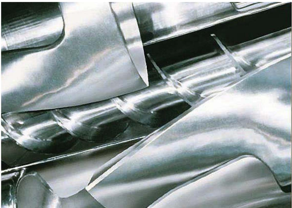
Abb. 15.4 Knetschaufeln im Kneiter mit Austragsschnecke (Werksfoto Coperion GmbH)
