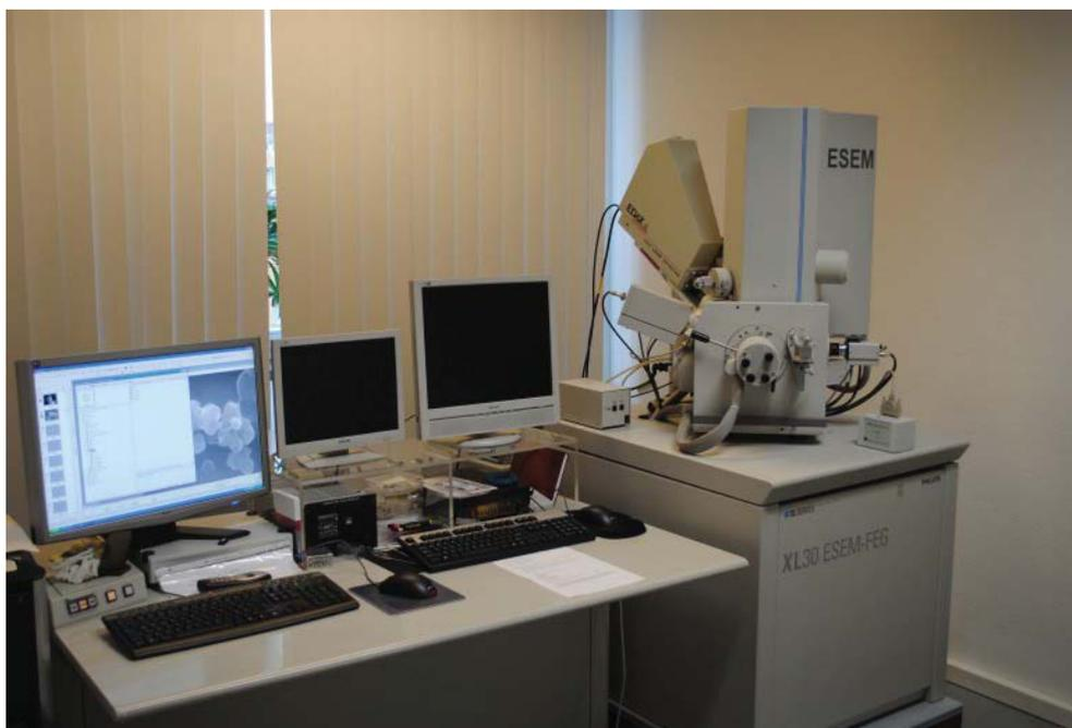
Abb. 42 ESEM Rasterelektronenmikroskop XL 30 (Bauhausuniversität Weimar)
