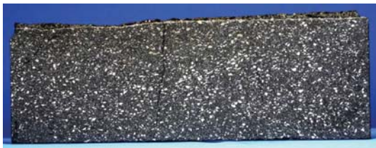
Abbildung 131: Sorte E nach dem Versuch mit der Schlacke
