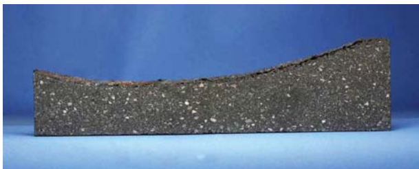
Abbildung 155: Variante mit 2% B_4C nach Kombiversuch (Schlacke und Lanze)
