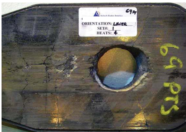
Abbildung 167: Versuchsplatte nach 4 Chargen
