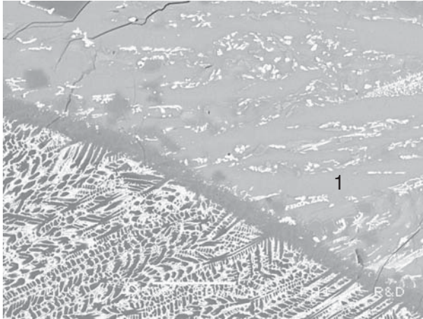
Abbildung 144: Rasterelektronenmikroskopisches Rückstreuelektronenbild der Variante 2 von Tabelle 36 - Lösung von Zirkonkorund
