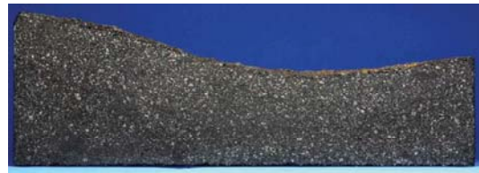
Abbildung 134: Sorte C nach dem Versuch mit der Lanze
