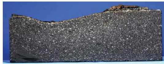
Abbildung 132: Sorte C nach dem Versuch mit der Schlacke
