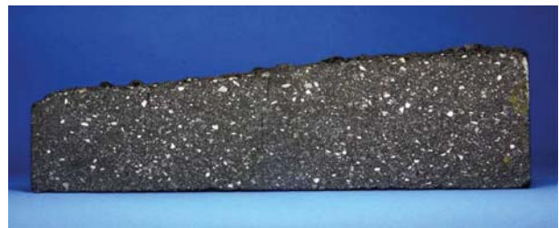
Abbildung 154: Standard mit 0,5% B_4C nach Lanzenversuch
