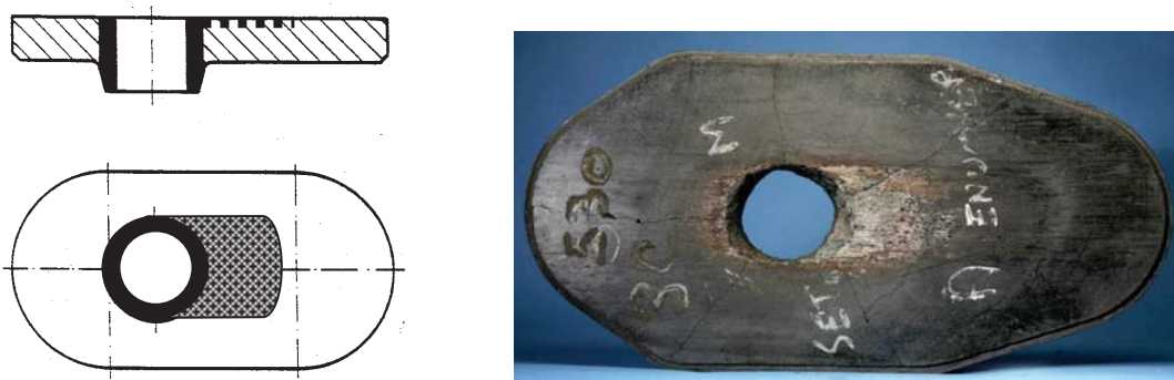
Abbildung 11: Lochausweitung und Arbeitsflächenverschleiß als ein Resultat der Korrosion
