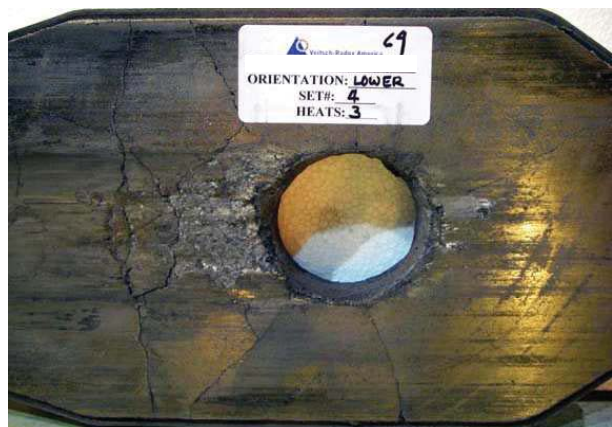
Abbildung 168: Versuchsplatte nach 3 Chargen
