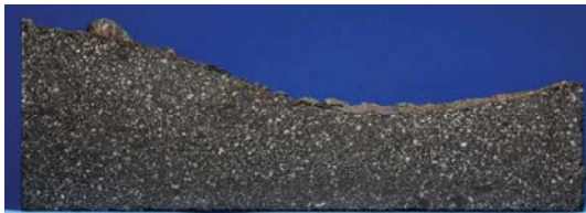
Abbildung 133: Sorte E nach dem Versuch mit der Lanze
