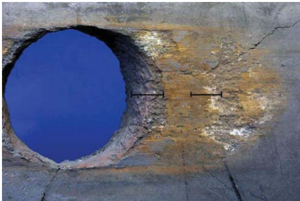
Abbildung 173: Bohrloch und Arbeitsfläche der gebrauchten Schieberplatte, die Entnahmestelle der Anschliffe sind markiert
