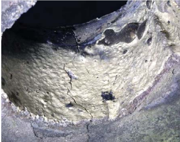
Abbildung 30: Bohrloch der Platte mit anhaftender Schicht
