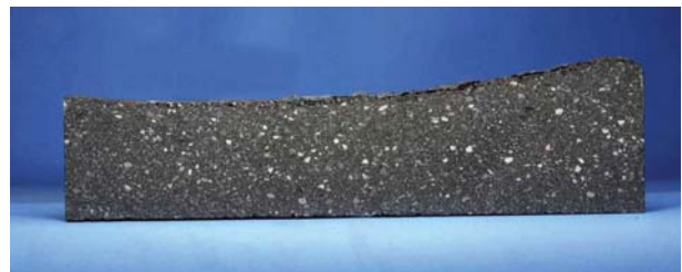
Abbildung 156: Standard mit 0,5% B_4C nach Kombiversuch (Schlacke und Lanze)
