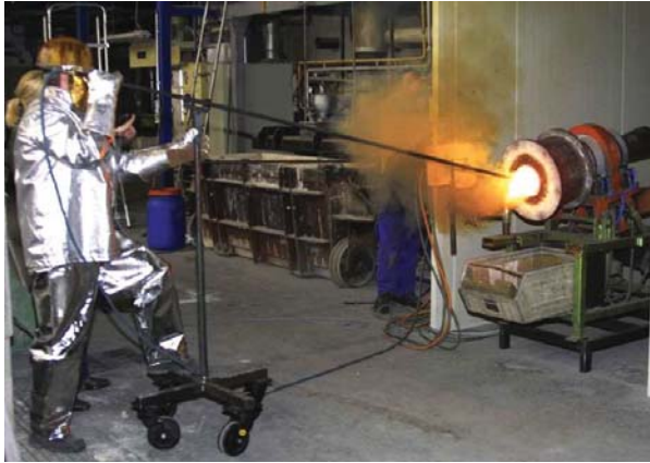
Abbildung 130: Freibrennversuch im Labormaßstab
