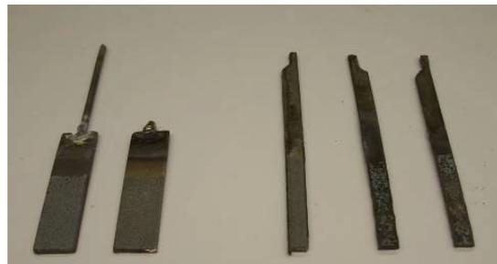
Abbildung 0-12: Diamantelektroden auf Ti-Oxid-Träger (links einseitig, rechts doppelseitig beschichtet)
