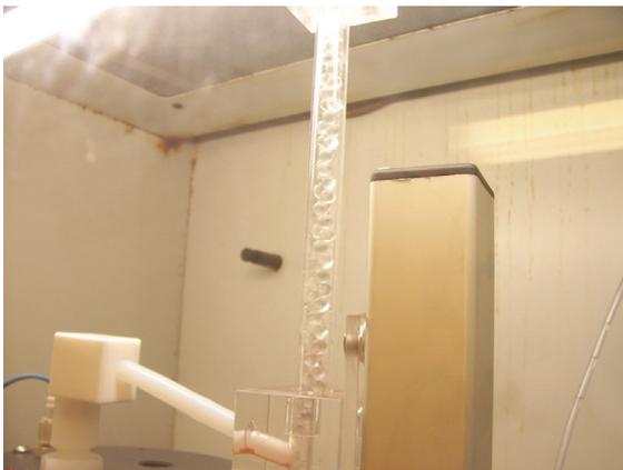
Abbildung 0-18: Reaktions-Säule mit Glasperlen, 6 mm
