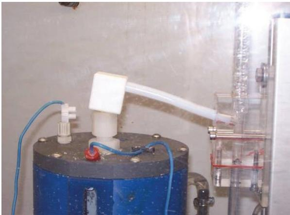
Abbildung 0-15: Zufuhr des generierten Ozons in die Reaktionssäule
