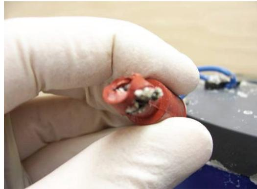
Abbildung 0-11: Keramikträger mit Gummierung
