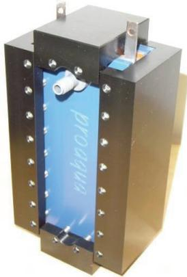
Abbildung 0-1: Reaktor für die Behandlung der UBA-Versuche
