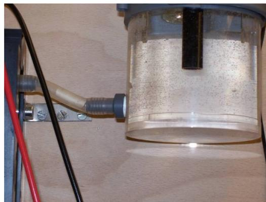
Abbildung 0-6: Ausschnitt der Meßarmatur, Blasenbildung aufgrund der Oxidationsmittel
