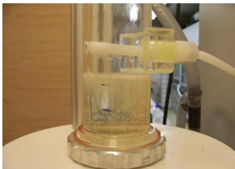
Abbildung 0-9: Eindüsung des erzeugten Ozons
