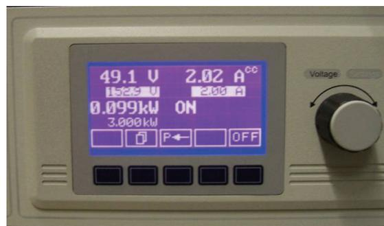
Abbildung 4-4: Netzgeräte-Display mit Soll- und Istwert
