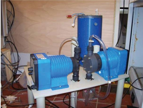
Abbildung 0-14: Weiterentwickelter Ozongenerator, links: Abwasserpumpe, rechts: Elektrolytpumpe
