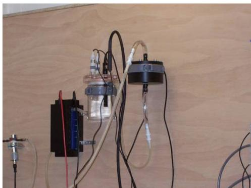
Abbildung 0-3: Reaktor mit Meßarmatur inkl. Sensoren und Katalysator
