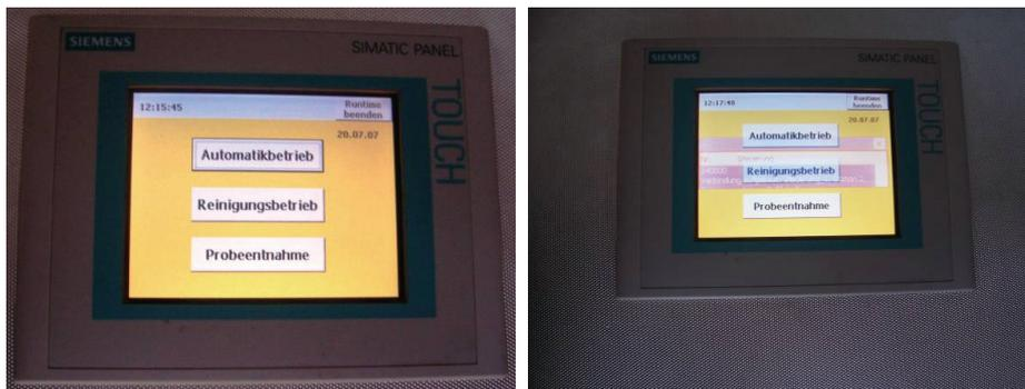
Abbildung 4-6: Programmoptionen (links); Abfrage der Ein- und Ausgänge der SPS-Steuerung (rechts)
