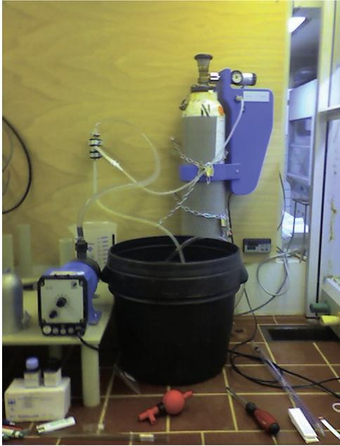
Abbildung 0-19: Ozonerzeugung mittels Corona-Entladung, Venturi-Injektor
