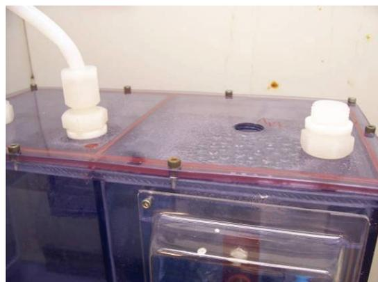
Abbildung 0-13: Prototyp d. Ozongenerator, links: O<sub>3</sub>-Öffnung, rechts: H<sub>2</sub>-Öffnung
