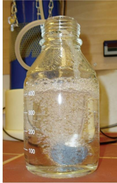
Abbildung 0-21: Einsatz einer porösen Kugel für die Kontaktierung mittels Blasensäule
