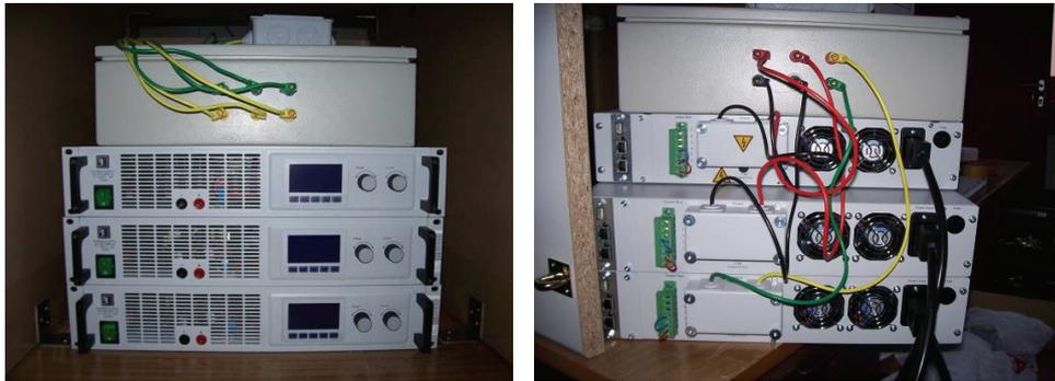
Abbildung 4-3: links: Netzgeräte von vorne; rechts: Anschlüsse der Netzgeräte hinten; oben: Umpoleinrichtung
