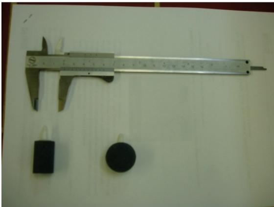
Abbildung 0-20: Poröse Körper für den Einsatz in einer Blasensäule
