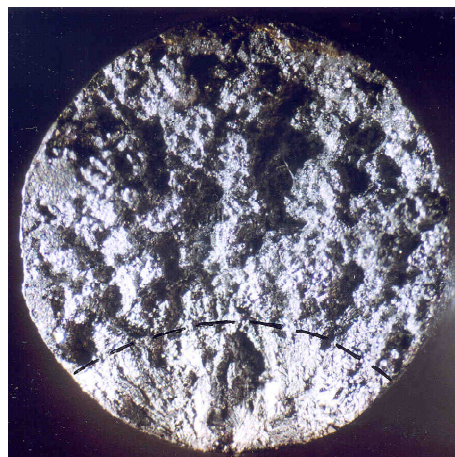
Abb. 4.6: Bruchfläche einer Rundprobe aus Ermüdungsversuchen nach Leitner [64]
