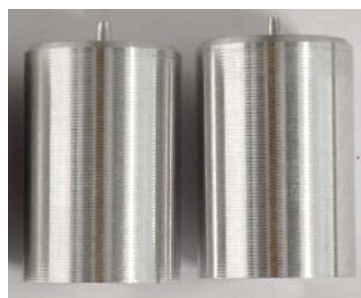
Abbildung 5.12: Probenkörper nach Drehoperation f = 0,4 \text{ mm} , a_p = 0,5 \text{ mm} , v_c = 240 \text{ m/min} ; links Legierung MIN, rechts MAX
