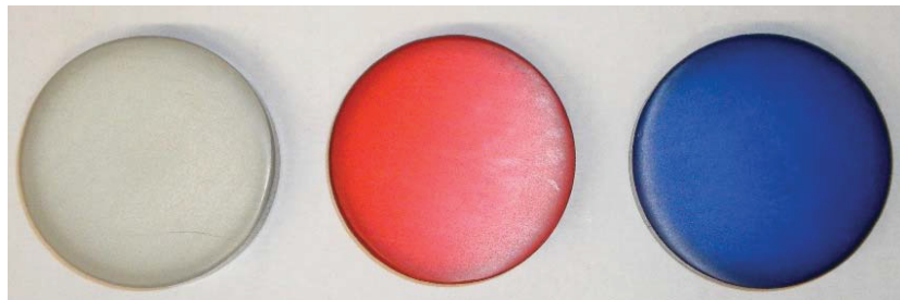
Abbildung 4.52: Eloxierte AlCuMgSn-Proben, links Eloxierprozess C0, Mitte C60, rechts C50
