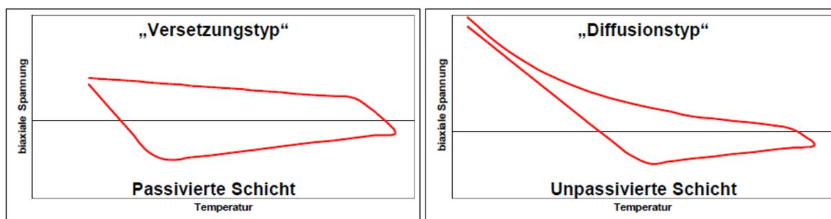
Abb. 5.1: Modell der biaxialen Spannungsevolution über der Temperatur für eine passivierte (Al Typ) und eine unpassivierte (Cu Typ) Schicht.
