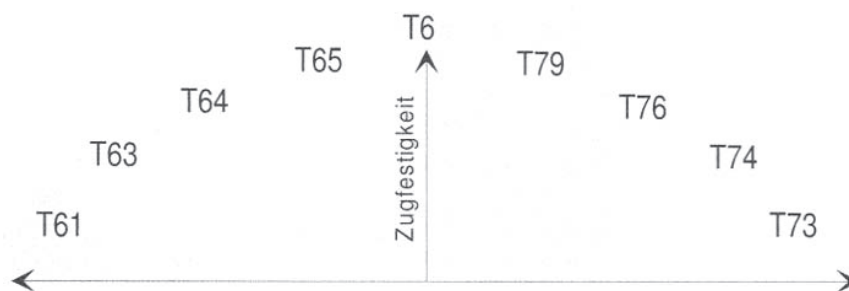
Abbildung 2.17: T6x und T7x Wärmebehandlungszustände mit entsprechender Festigkeit [38]
