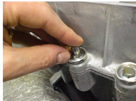
(b) Manuelles Anlegen des Prüfkopfes
