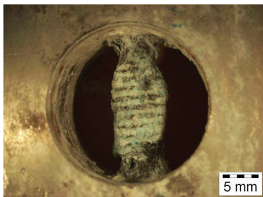
(a) 7075-T6 Schraube in SS304 Edelstahl-Rahmen (4 Zyklen)
