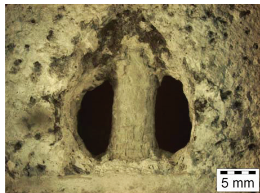
(d) 7075-T6 Schraube in Magnesium-Rahmen (10 Zyklen)
