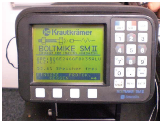
(a) US-Messgerät BoltMikeII
