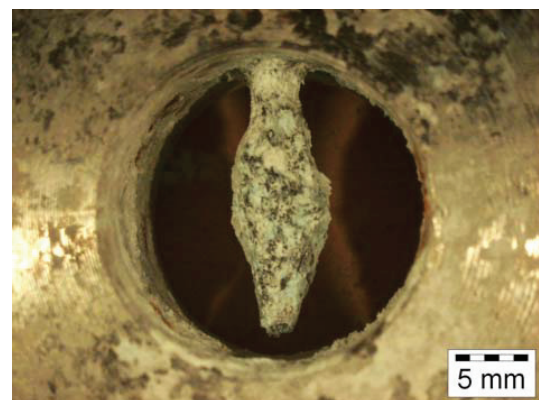
(b) 7075-T6 Schraube in SS304 Edelstahl-Rahmen (10 Zyklen)
