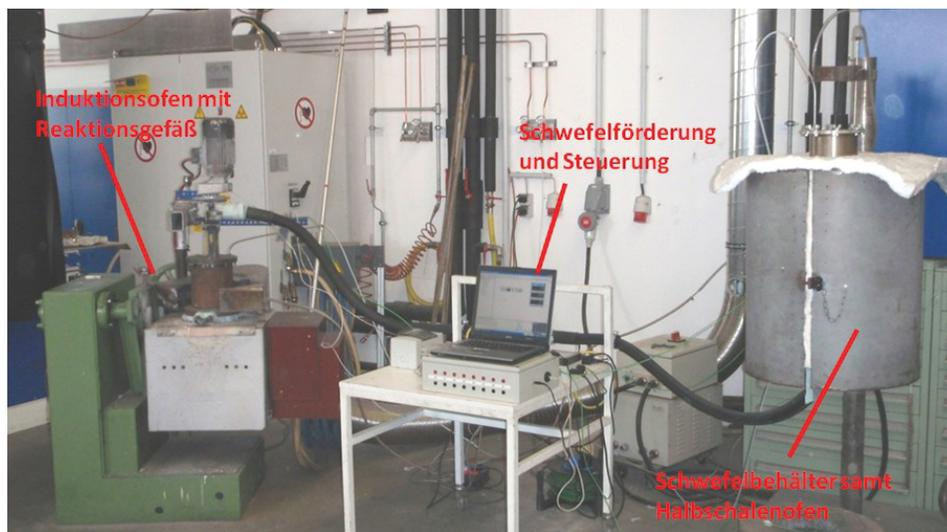
Abb. 5.17: Darstellung der gesamten Anlage zur Erzeugung von Metallchalkogeniden
