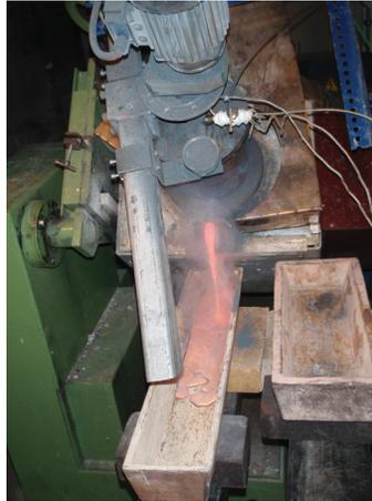
Abb. 5.16: Abguss der erzeugten Metallchalkogenidschmelze
