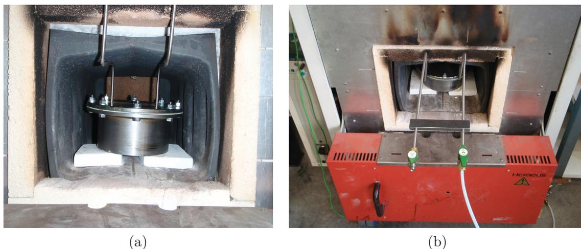
Abb. 4.29: Versuchsaufbau – Herstellung Zinn(IV)-sulfid: (a) Reaktionsgefäß; (b) Muffelofen
