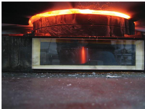
Abb. 7.10: Darstellung des Schmelzestrahls während des Verdüsungprozesses
