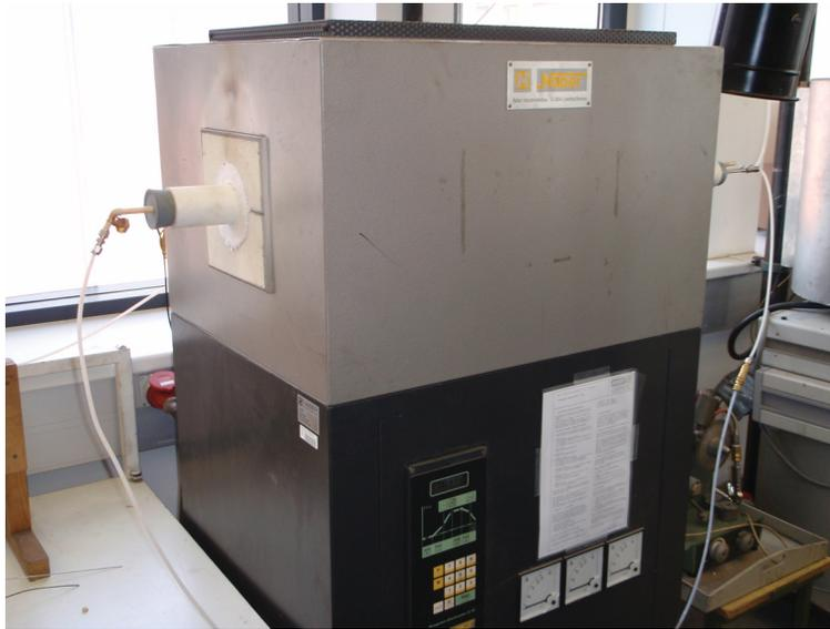
Abb. 8.3: Widerstandsofen als Versuchsaggregat zur Raffination von Zinnsulfid
