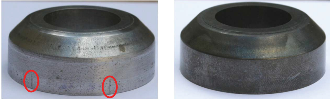
Abbildung 21.4: Zylinderproben die bei Raumtemperatur (a) und 500 °C (b) zur Endgeometrie der Kegelproben verpresst wurden. An der kalt verpressten Proben sind Riefen (rote Ovale) und eine geringere Ausformung erkennbar [Sch10].
