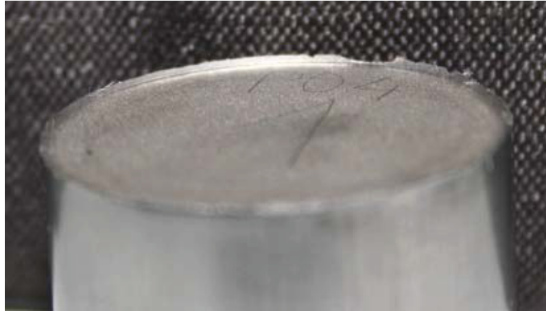
Abbildung 10.12: Der Rand der auslaufenden Stirnseite einer verpressten Probe zeigt einen rundumlaufenden Grat in Folge des radialen Materialflusses.
