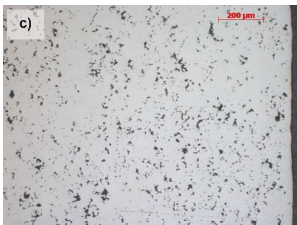
Abbildung 20.3: Schliffbilder des Bereichs M2 in 100-facher Vergrößerung für Proben des Versuchsblocks 2. Für Temperaturdifferenzen von Werkzeug und Werkstück bis 100\text{ °C} wird kein Einfluss auf die Dichteverteilung festgestellt. Eine Differenz von 150\text{ °C} bewirkt eine erhöhte Randdichte.
