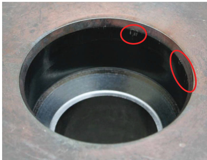
Abbildung 21.5: Schäden an der Kegelmatrize (rote Ovale) nach dem Umformen einer kalten Zylinderprobe [Sch10].
