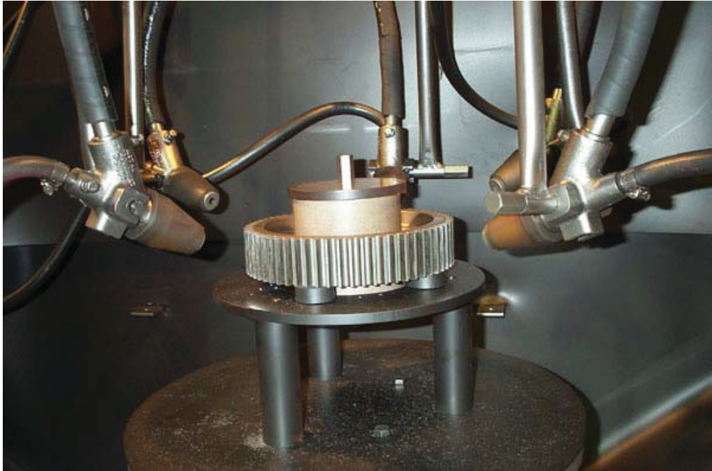
Abbildung 3.5: Mehrdüsiges Strahlen eines Bauteils in einer geschlossenen Kammer [Pla07].
