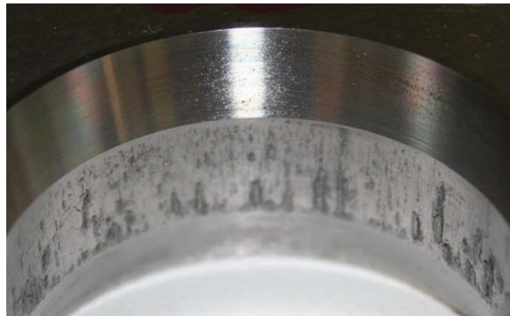
Abbildung 10.13: Anlagerungen von abgeriebenem Probenwerkstoff an der Matrize.
