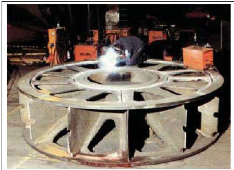
**Abb. 2.24:** Rotor eines Rohrgenerators beim Schweißen [2.25]
