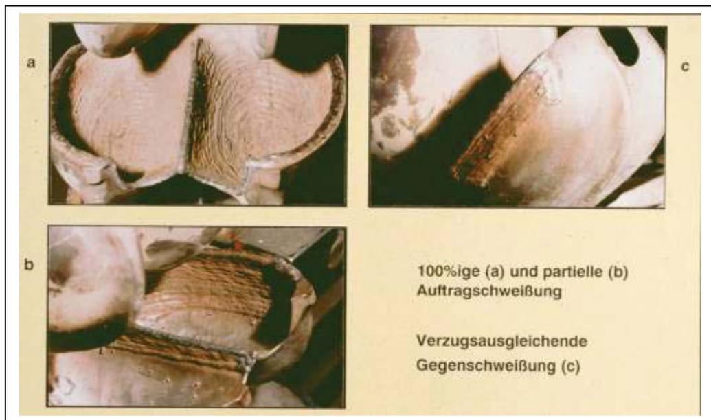
**Abb. 2.18:** Schweißreparatur eines Peltonlaufrades [2.22]
