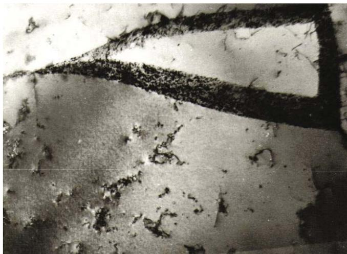
**Abb.: 5.8:** Debrisstruktur,  $V=30\ 000x$  [5.10]
