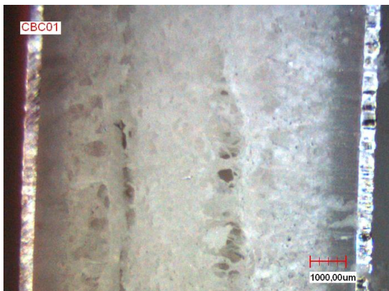
Abbildung 147b: Sandwichverbund mit Schaumkern aus Blend 40/40/20 mit 0,1 Gew.-% NUC 5532. Die Schweißstellen der Stränge sind erkennbar.
