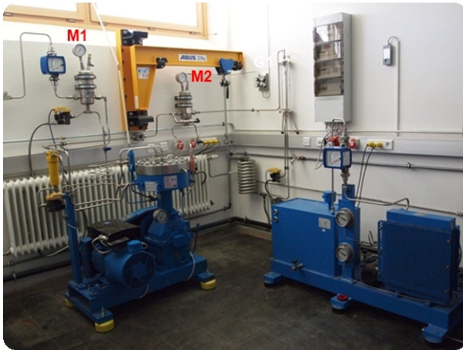
Abb. 5.11: Rechte Teilansicht der ErCo 2 Versuchsanlage mit folgenden Anlagenkomponenten: Gasverdichter, Sicherungskasten, Kühlaggregat, Servicekran, (M1 ... druckseitiges Druckmanometer; M2 ... saugseitiges Druckmanometer)
