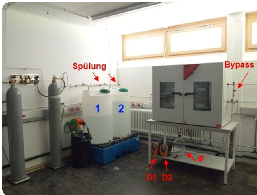
Abb. 5.9: Linke Teilansicht der ErCo 2 Versuchsanlage mit folgenden Anlagenkomponenten: Gasversorgung, Flüssigkeitsbehälter, Dosierpumpen und Wärmeschrank
