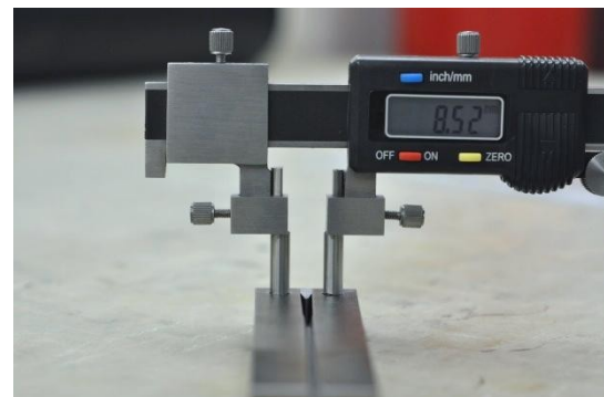
c) Darstellung des Ausmessens für die Aufweitung
