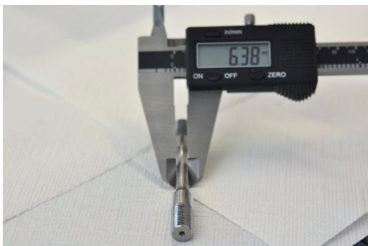
b) Abmessen des Durchmessers der Messlänge
