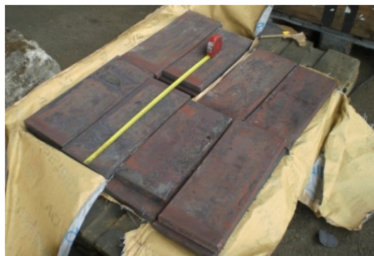
Abbildung 6-3: Darstellung der Versuchschargen mit den Abmessungen 400 mm × 170 mm × 30mm (L × B × H)
