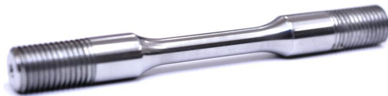
a) Zugprobe nach NACE Standard TM0177 Methode A
