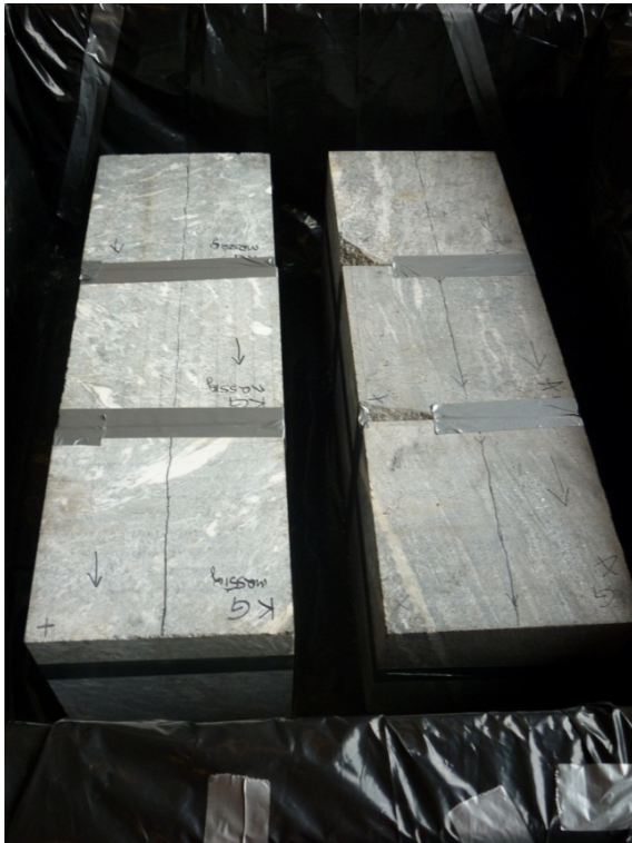
Abb.4.14: Anordnung der Gesteinswürfel in der noch nicht betonierten Probenwanne. (MORI, 2012)
