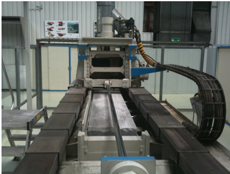
Abb.4.6: Foto des Linearschneidprüfstands mit Grundgerüst, Schlitten, Führung, und Probenwanne. Die einzelnen Gesteinsblöcke sind hintereinander in der Wanne eingespannt.
