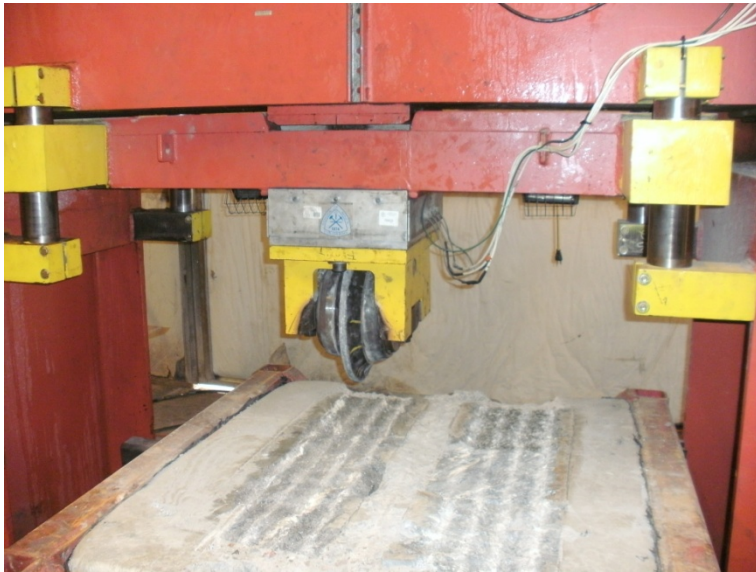
Abb.4.12: Schneidprüfstand an der Colorado School of Mines.
