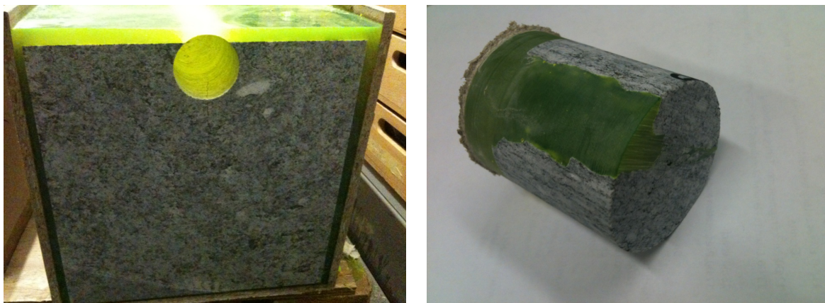
Abb.5.2: Gezogener Bohrkern aus der Gesteinsprobe direkt unter den Schnitt mit der Diske.
