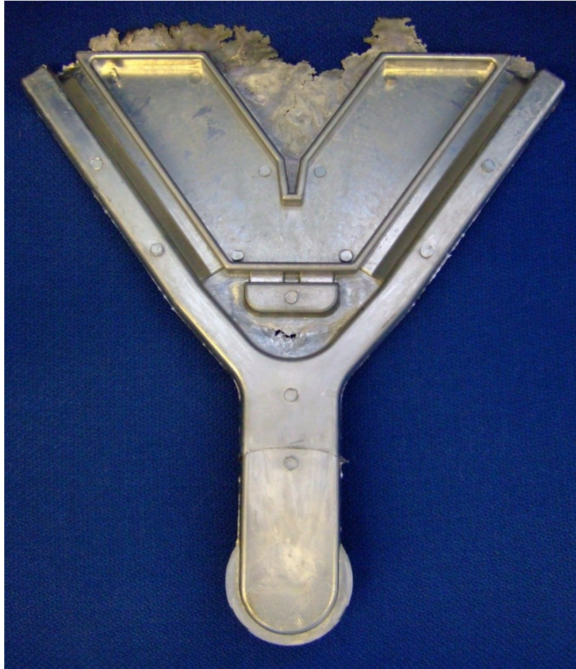
Bild 4.12: V-Probe im Gusszustand; Im Bereich der Bohne sowie in der Öffnung des „V“ sind dünne Fahnen vorhanden.
