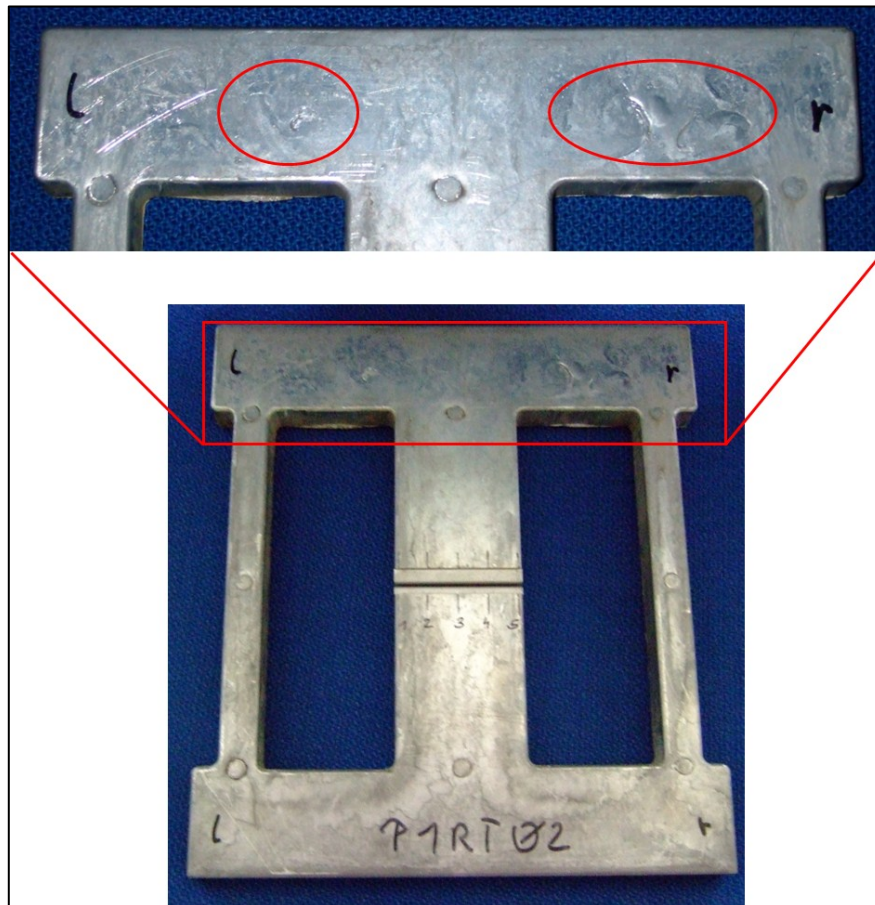
Bild 4.11: Spannungsgitterprobe bei einer Formtemperatur von 140 °C abgossen; im vergrößert dargestellten Bereich sind Kaltläufe deutlich sichtbar.
