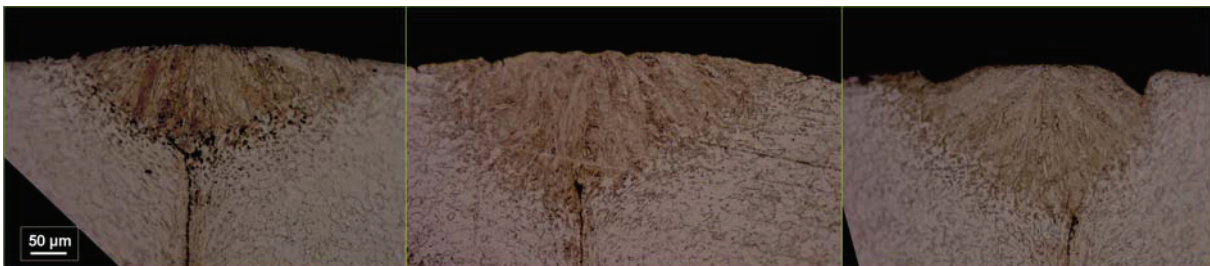
Abbildung 149: Schlifffbilder bei unterschiedlicher Fokuslage des Laserstrahls
