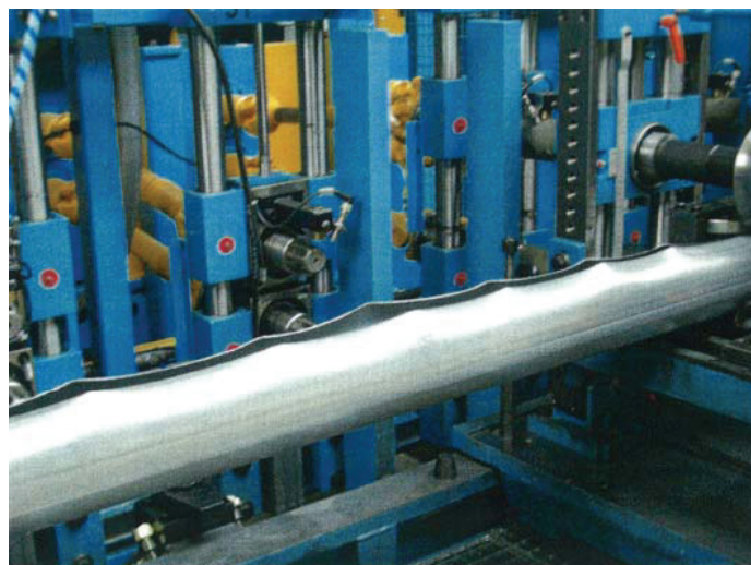
Abbildung 13: Welligkeiten an einem Rohr [Bru04]
