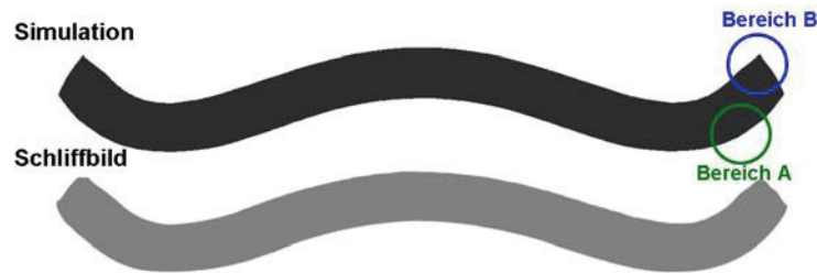
Abbildung 110: Vergleich zwischen Kontur der Simulation (oben) und Schliffbild (unten) nach der ersten Station, durch das feinere Netz tritt keine Gegenbiegung in der Simulation auf und die Kantendeformation ist geringer, die Konturen ähneln sich
