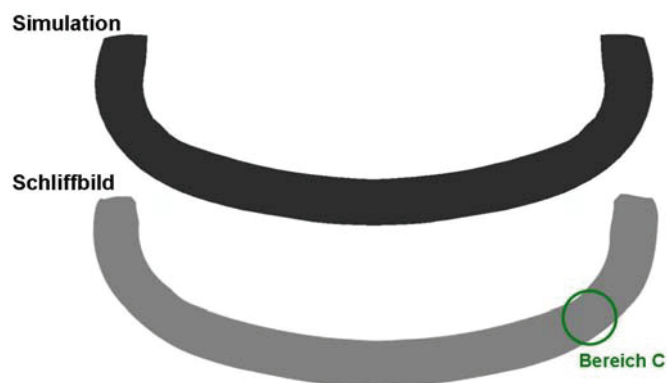
Abbildung 111: Vergleich zwischen Kontur der Simulation (oben) und Schliffbild (unten) nach der zweiten Station, im Bereich C kommt es zu einer Verdünnung und darüber zum Aufstauchen des Materials
